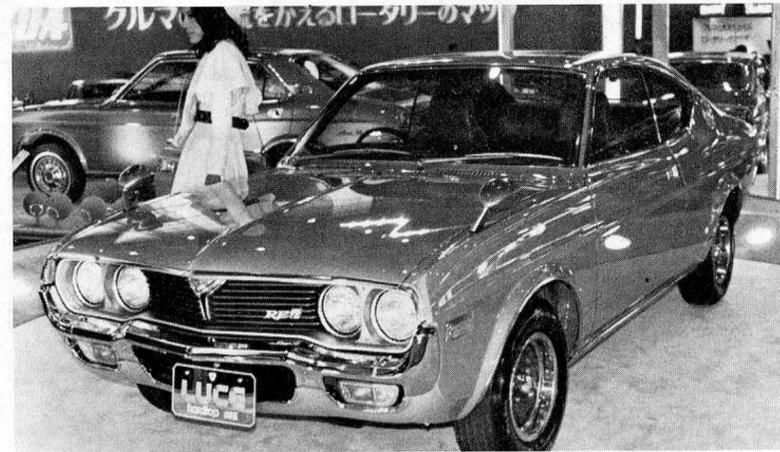
A sinistra, la concreta «proposta» Yamaha: un Wankel birotore raffreddato ad acqua. A destra, la Mazda New Luce, con doppio rotore antinquinamento destinata agli Stati Uniti. Sotto, la Chantez EV, city-car elettrico della Mazda, ha un'autonomia di 65 km ed una velocità massima di 60 kmh
