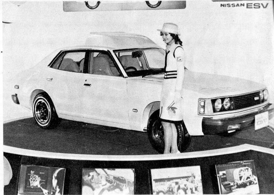
rigido e protetto, con parti a sbalzo ad alta deformabilità. Oltre ai soliti massicci paraurti, utilizza speciali pneumatici a due camere d'aria che consentono una velocità massima di 80 kmh in caso di foratura. Completa la sicurezza dei pneumatici uno speciale sistema elettronico chiamato «nastac» che informa di una anormale temperatura o di un abbassamento della pressione di gonfiaggio. I cuscini di sicurezza gonfiabili assicurano l'incolumità dei passeggeri fino a 65 kmh.
