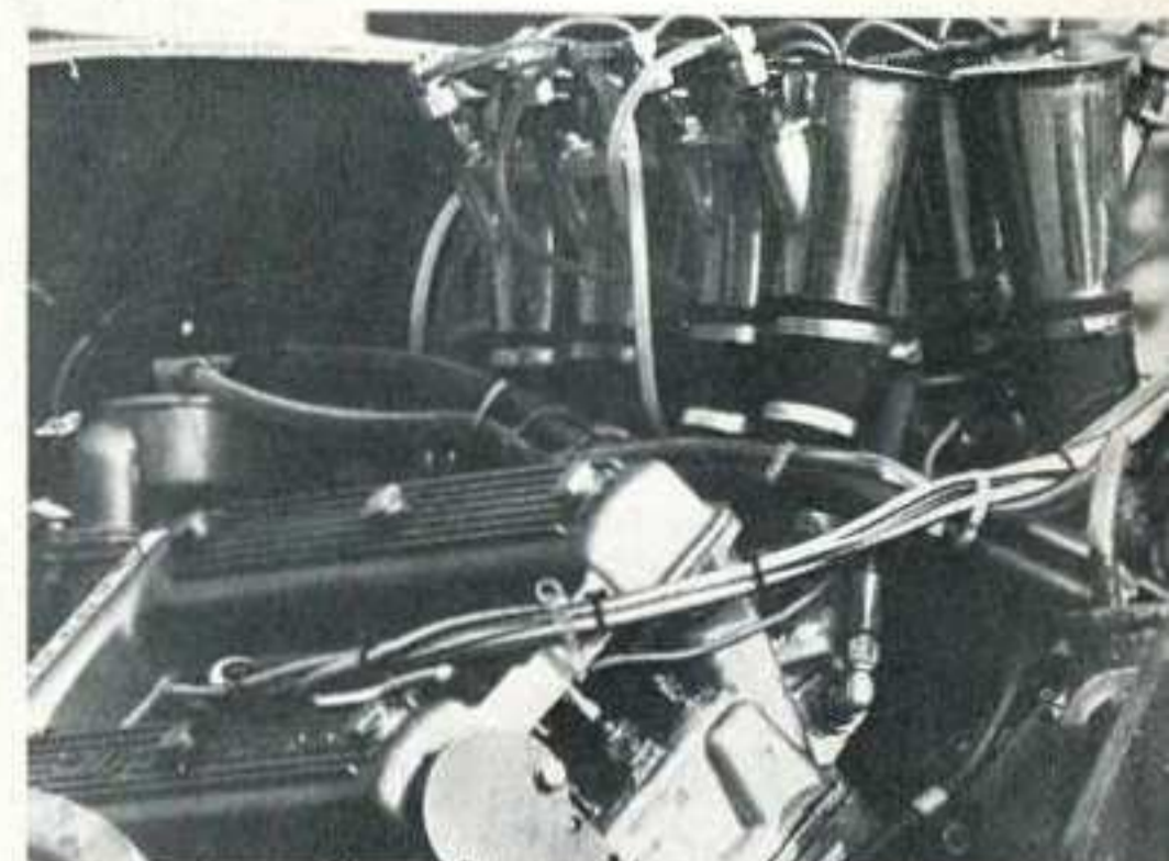
A sinistra: veduta d'insieme del « locale macchine ». Si rinuncia in questo caso al raffreddamento dello scarico e relativo ricupero di calore. In primo piano il grosso distributore di accensione Magneti Marelli, coadiuvato nelle sue mansioni dal noto Dinoplex a scarica capacitiva. Sotto: Lasciateci ricordare quando abbiamo già visto quell'insieme di « Venturi » con relativi iniettori di benzina... Dev'essere stato nel '33!
