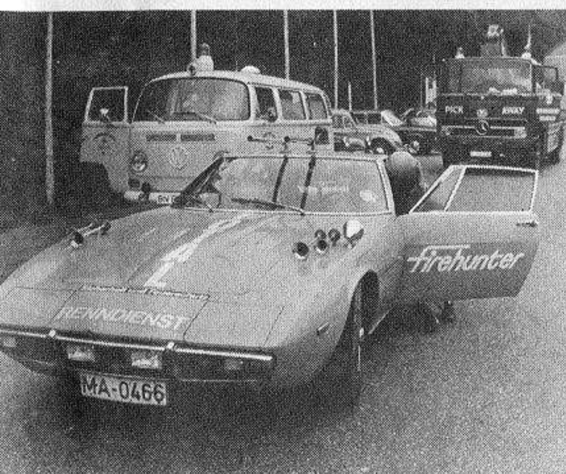
Nella foto in alto: il casco parafuoco degli addetti al servizio antincendi di Silverstone: bene. Ma l'abbigliamento? Qui sopra: ecco la Maserati Mexico «firehunter» (cacciatore di fuoco) in servizio al Nurburgring. Una vettura rapidissima attrezzata con due cannoncini ad uso simultaneo per lancio dello schiumogeno per soffocare le fiamme
