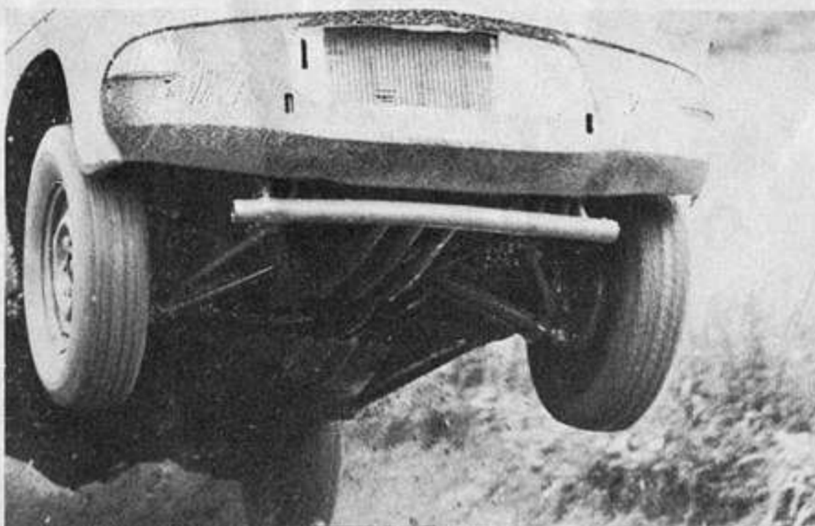
Dalla foto sopra, traspare evidente l'esigenza di irrobustire e proteggere le zone ventrali delle auto dedicate a questo sport. Sotto, i Buggies se la cavano ugualmente molto bene anche senza le dune
