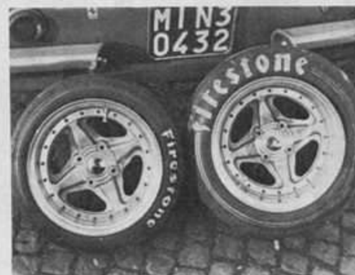
Sopra, la Delta F. Ford utilizza i portamozzi anteriori della Standard Triumph. Sotto, i nuovi cerchi scomponibili, realizzati nel diametro di 13"
