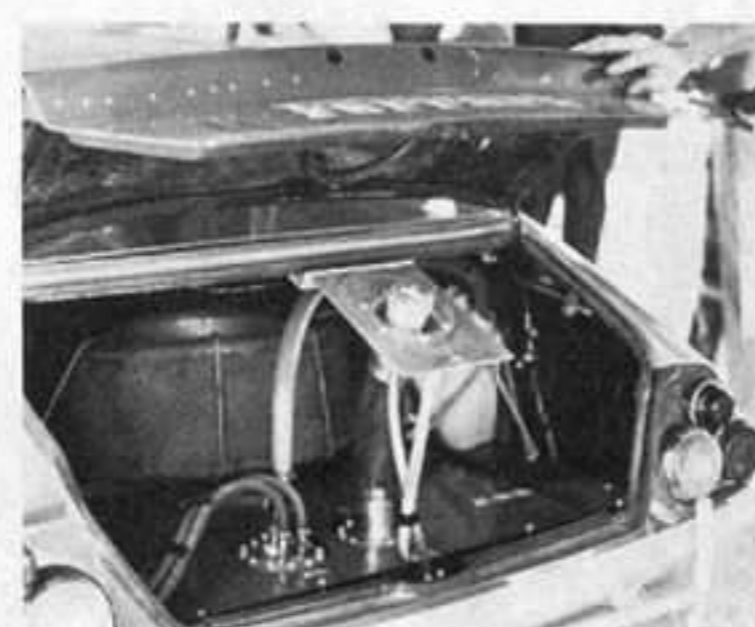
Il serbatoio carburante della Daytona, con il sistema di tubature di tipo aeronautico, ed il pratico bocchettone esterno per il riempimento rapido
