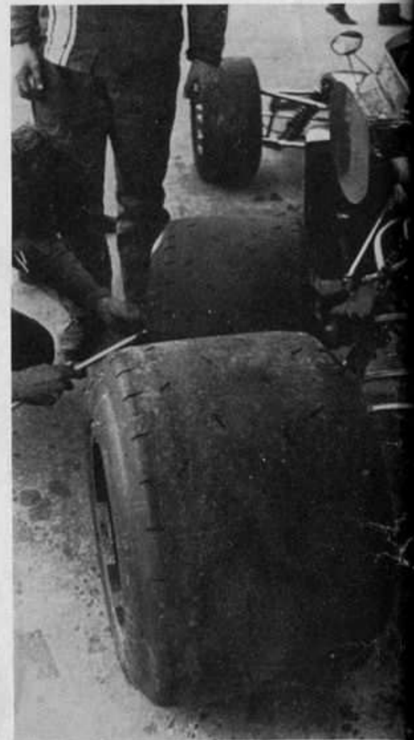
Sopra e a destra si lavora sulla March di Peterson per montare posteriormente le G.Y. da 17 pollici morbidissime usate in prova
