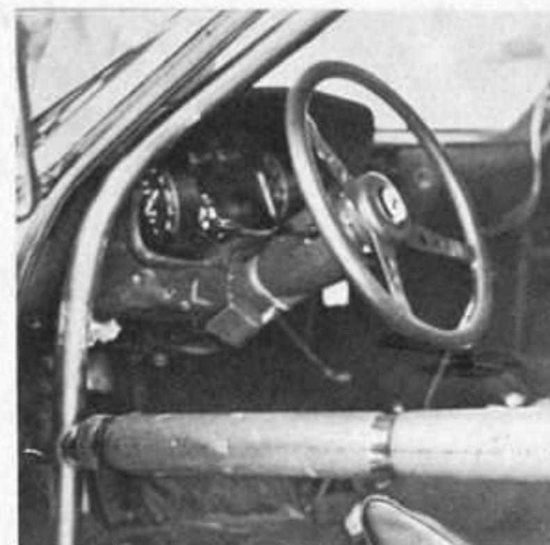
Una Ferrari Daytona alla moda americana. L'interno della macchina è stato dotato di una robustissima gabbia di tubi di acciaio. Sotto: tra le modifiche alla Daytona-White c'è un nuovo radiatore. L'accensione è a doppio Dinoplex, come in origine
