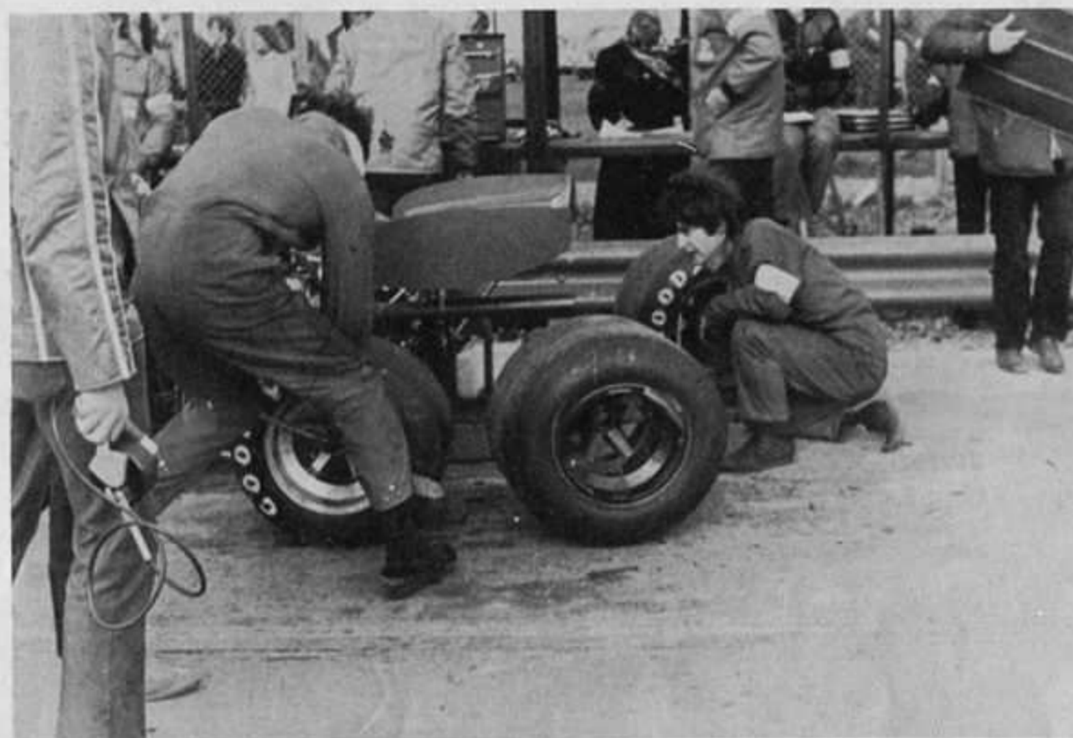
Sopra e a destra si lavora sulla March di Peterson per montare posteriormente le G.Y. da 17 pollici morbidissime usate in prova
