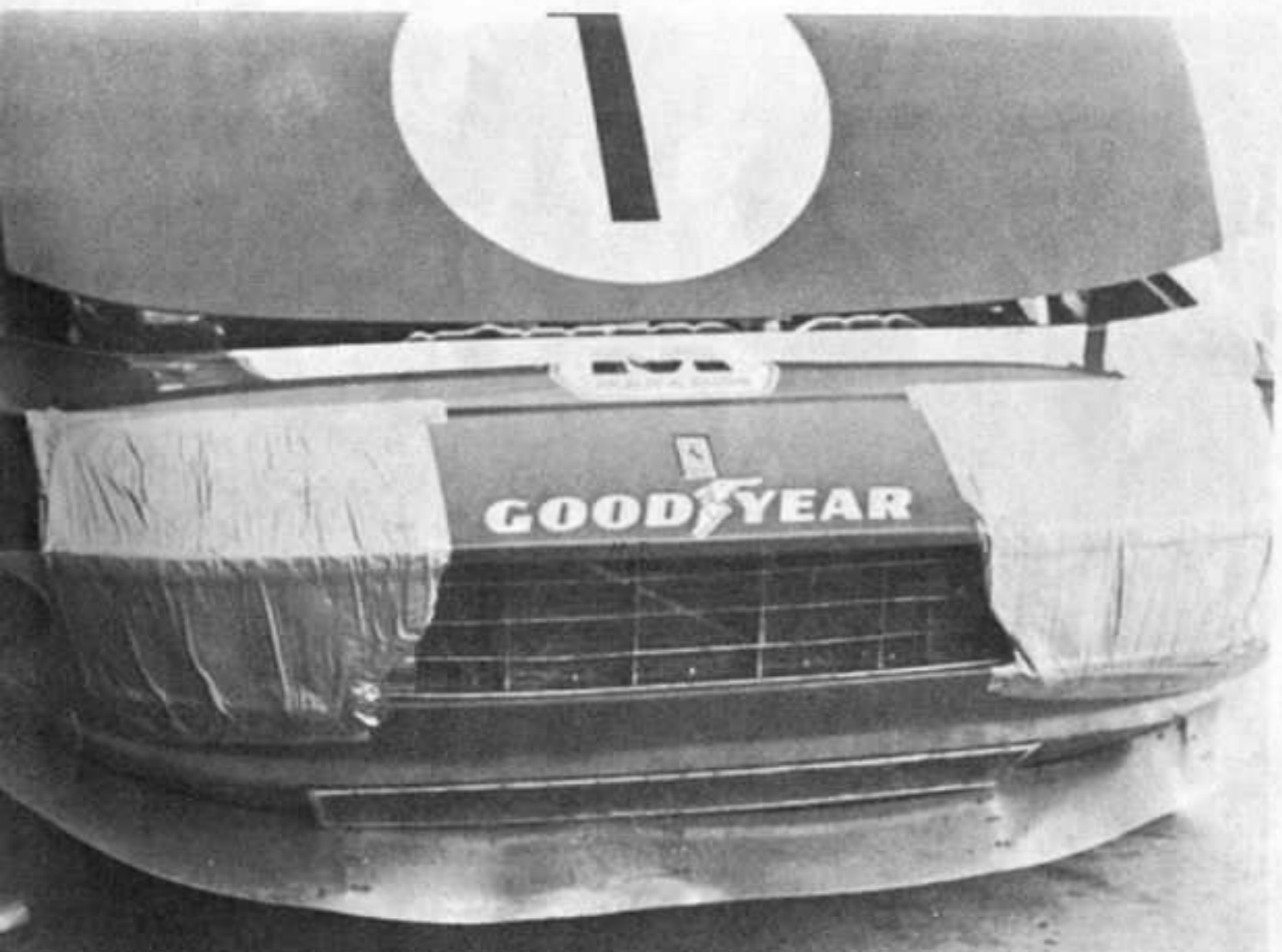
Il muso della Daytona di White. Eliminato il plexiglas il radiatore è libero. Ai lati le prese d'aria per il raffreddamento dei freni
