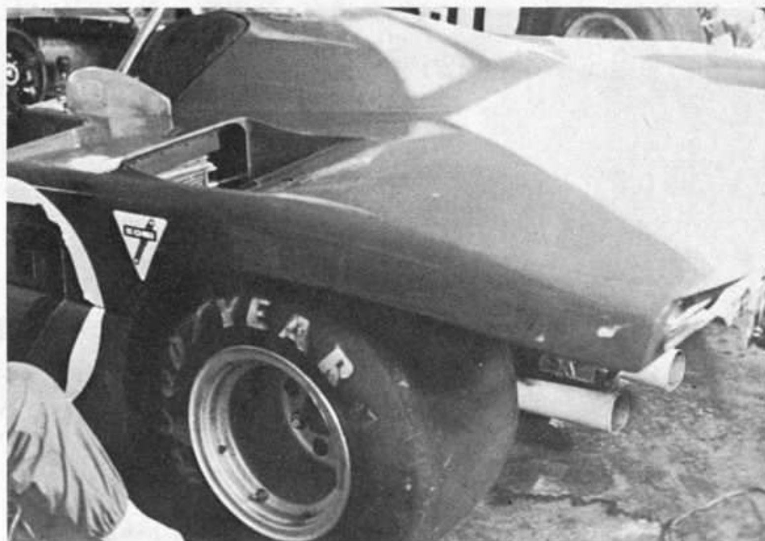
La coda allungata delle Alfa Romeo modificate. Si nota l'uscita dell'aria dietro i radiatori olio ora posti sopra quelli dell'acqua
