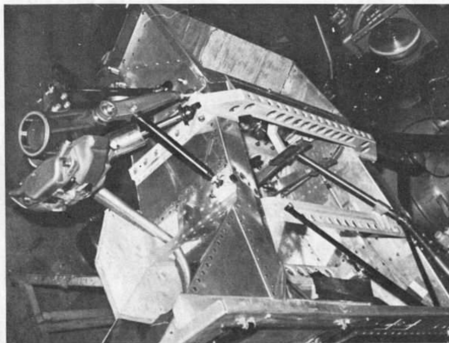
Sopra, il telaio scatolato della Mirage Sport è un bellissimo lavoro della Gomm Metal Developments di Old Woking, nel Surrey. Sotto, la sospensione anteriore della Mirage, con sospensioni e freni fuoribordo. La scocca e le travi sono d'acciaio, poiché la vecchia Mirage 1969, nella sua versione in alluminio, cadde a pezzi per le sollecitazioni della gara. La Mirage M6 è ancora a corto di preparazione
