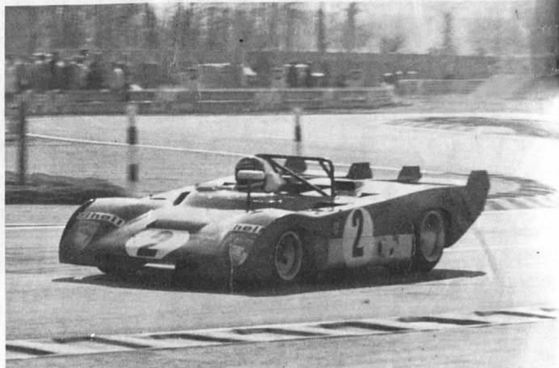
La Ferrari versione coda lunga, avrebbe toccato — secondo un calcolo dei tecnici modenesi — i 320 all'ora, sul rettilineo delle Hunaudieres. E' risultato che la 312 P con coda normale appena ritoccata si adatta meglio al nuovo percorso della Sarthe. Però con la coda lunga il consumo diminuisce sensibilmente.
