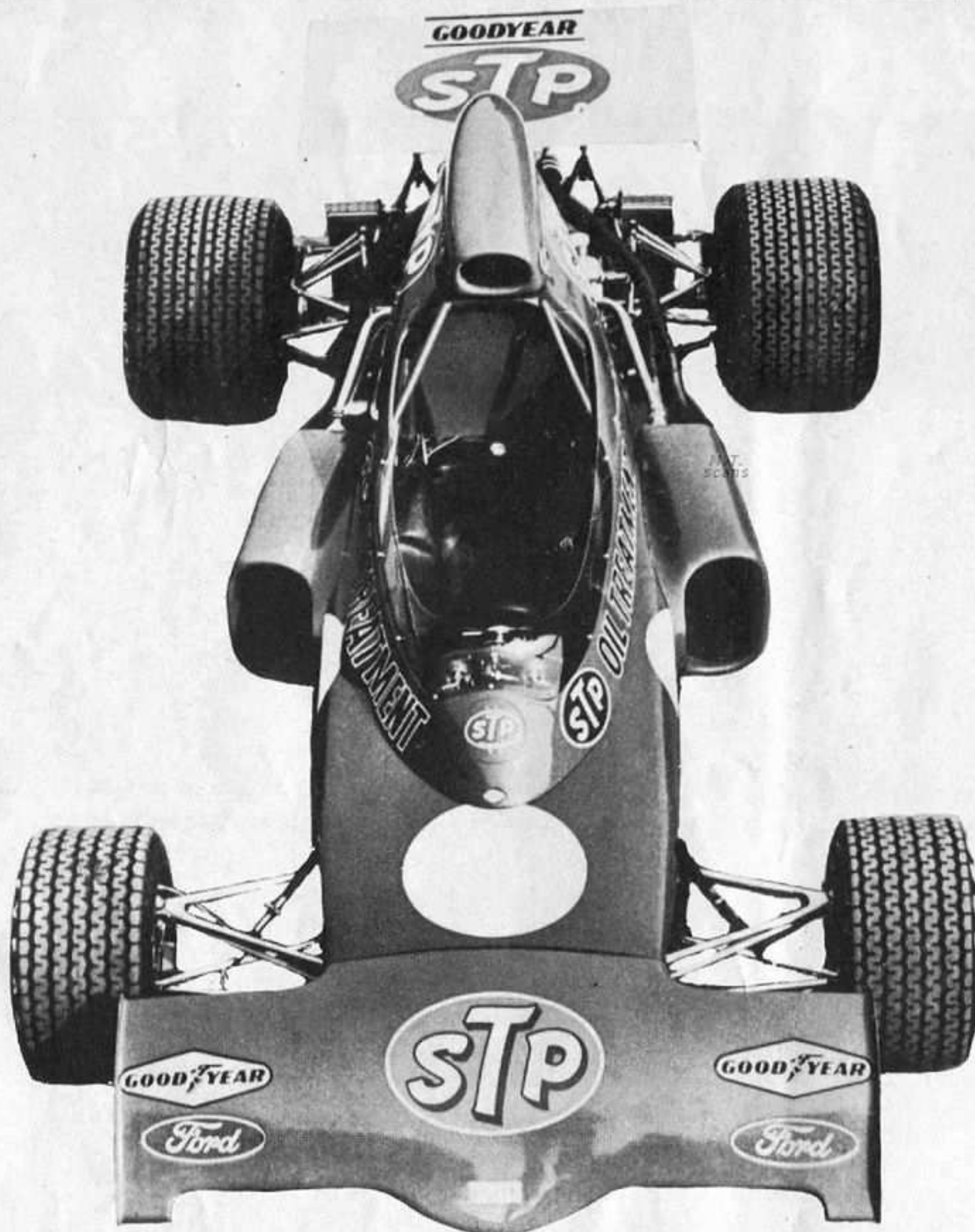
Sembra ancora più corta vista dall'alto la nuova March 721 X di Ronnie Peterson. Abbastanza singolare è la gabbia che protegge l'abitacolo: serve per proteggere il pilota nel caso che la vettura si infili sotto barriere Armco
