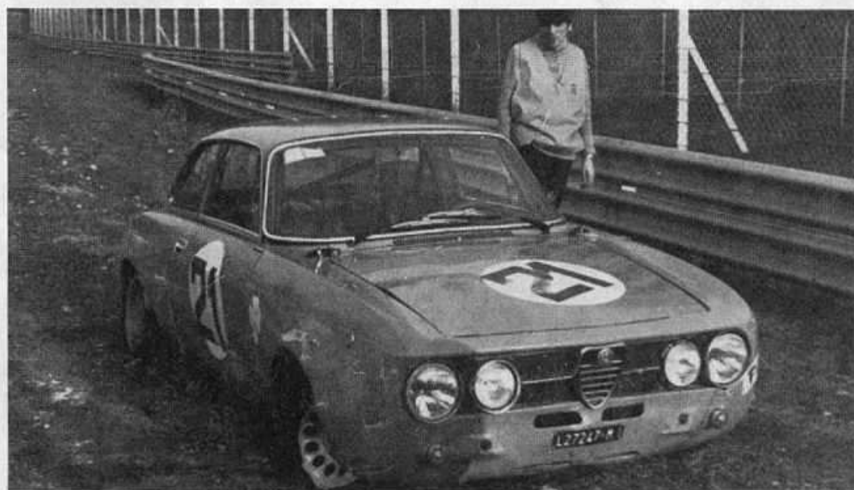
Al termine del curvone, ecco la GTAm di Carluccio Facetti, dopo il brutto «volo» in piena velocità. La causa la vediamo nella foto sotto: il semiasse si è rotto, e la ruota posteriore sinistra si è sfilata
