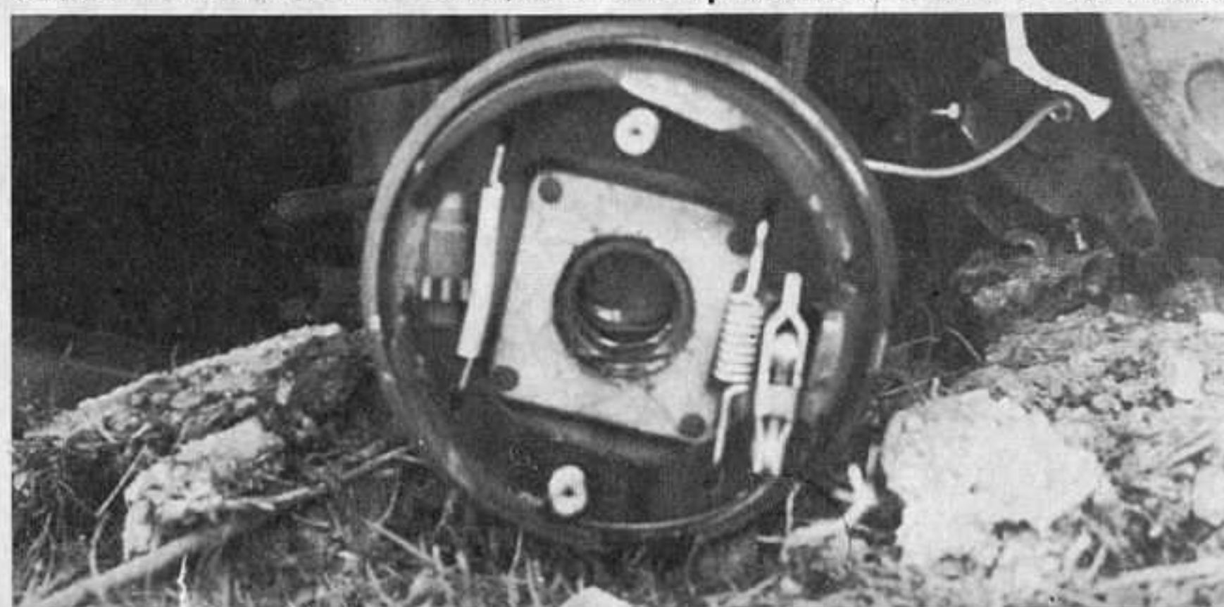
Al termine del curvone, ecco la GTAm di Carluccio Facetti, dopo il brutto «volo» in piena velocità. La causa la vediamo nella foto sotto: il semiasse si è rotto, e la ruota posteriore sinistra si è sfilata
