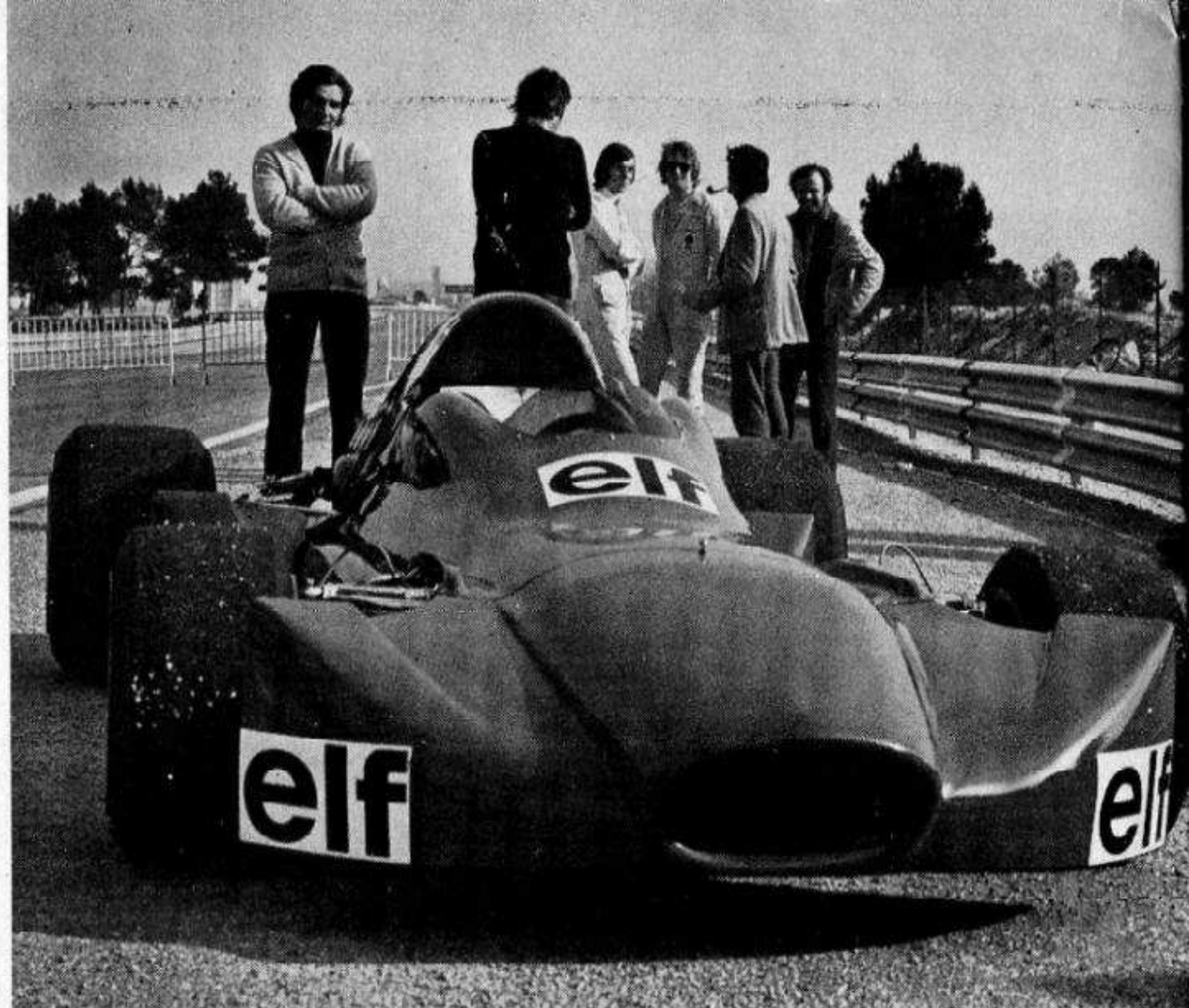
Sopra, questa vettura apparentemente anonima è la nuova Elf formula 2, con telaio e carrozzeria inconfondibilmente Alpine, ma con motore Cosworth. A destra, la «schiena» a gradini con i fori di evacuazione dell'aria. E' previsto naturalmente anche un alettone
