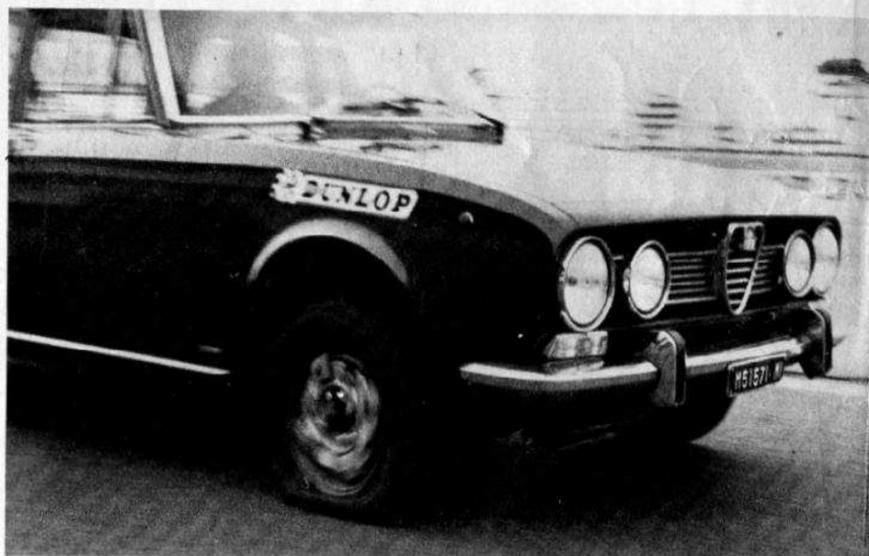
Le prove sono state effettuate con vetture di molte marche diverse. Sopra, ecco un'Alfa 1750 in velocità con la gomma anteriore destra sgonfia. Sotto, nelle stesse condizioni, vediamo una Renault R 12
