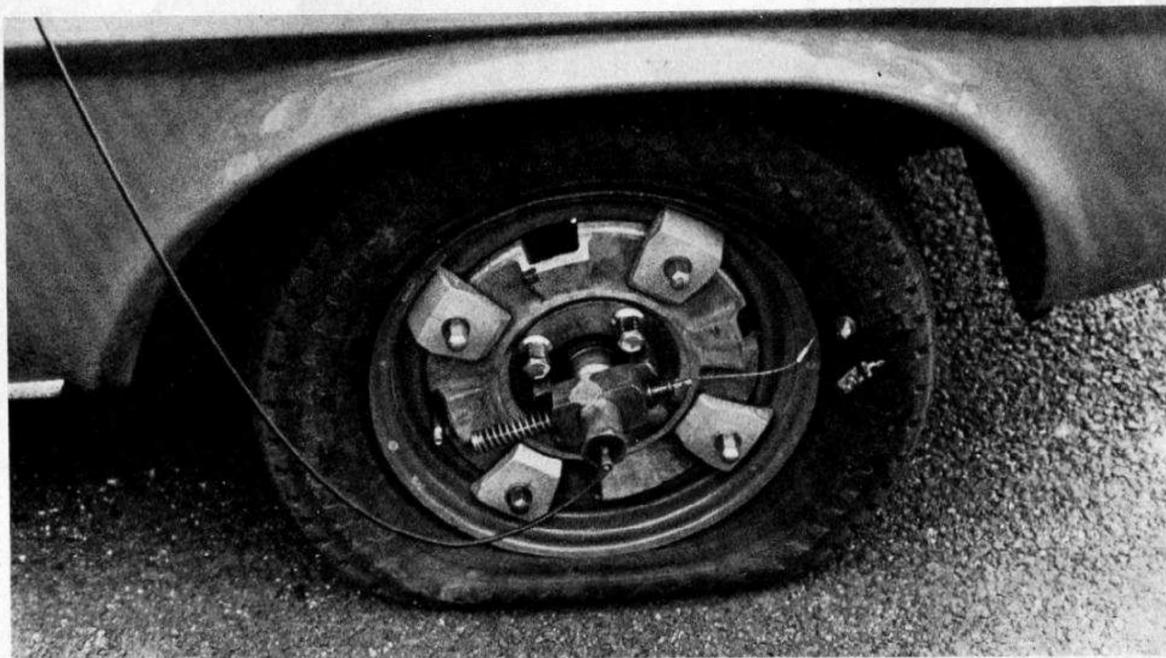
Con questo apparecchio viene «esploso» fuori dalla gomma un tassello cilindrico di 2 cm di diametro, sufficiente allo sgonfiamento immediato. Dopo si possono fare ancora moltissimi chilometri
