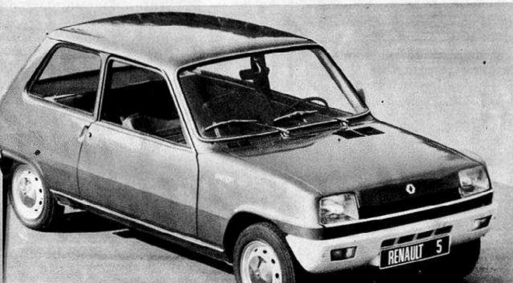
Sopra, un tre-quarti anteriore della Renault 5. In questa macchina il motore anteriore è longitudinale, ma interno al passo. Sotto, il grafico delle velocità a seconda dei giri e della marcia inserita
