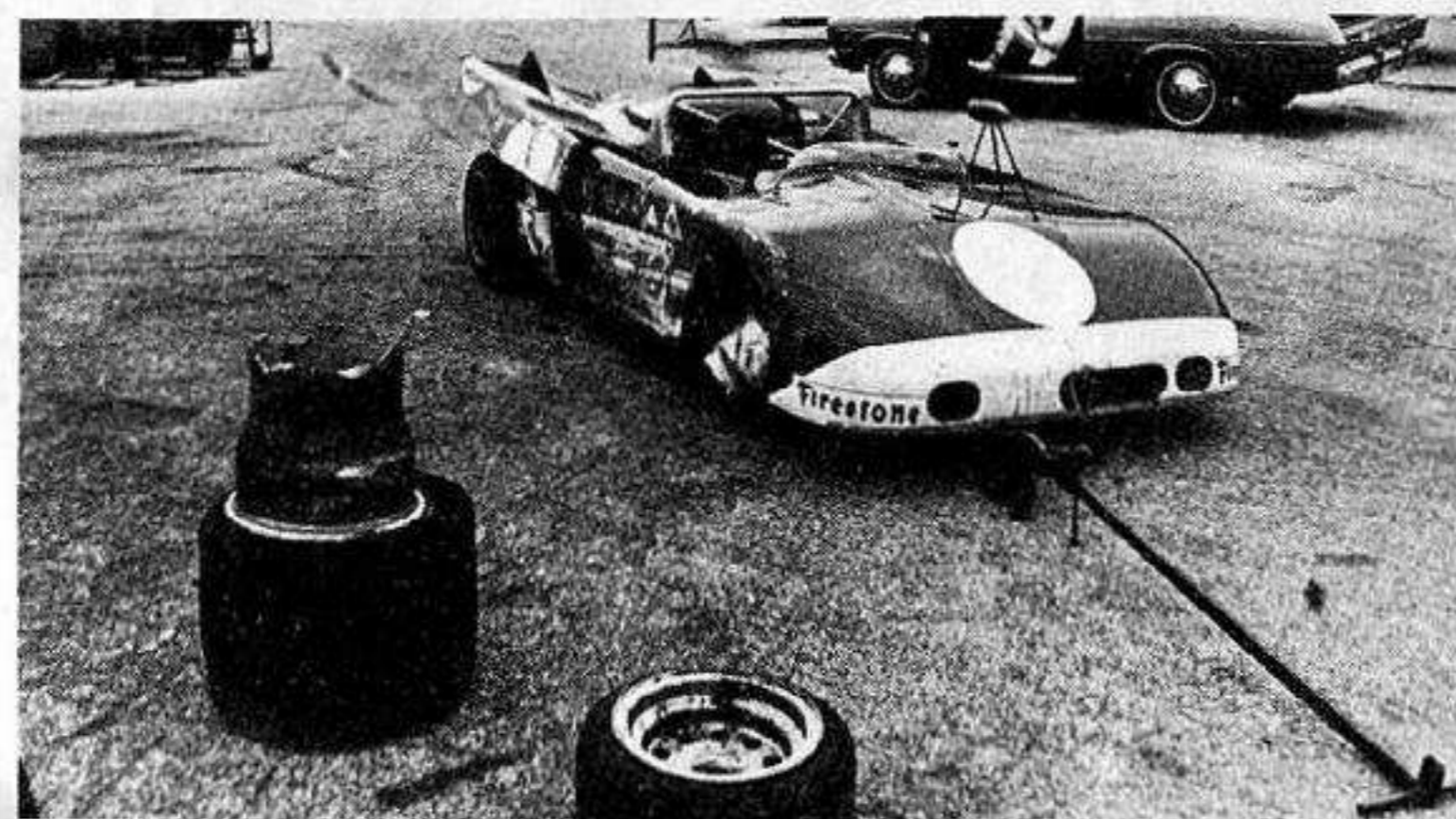
Lo scoppio della gomma anteriore destra ha portato la macchina di de Adamich contro il muretto di protezione. Le gomme sono state il grosso problema dell'Alfa in questi allenamenti a Daytona
