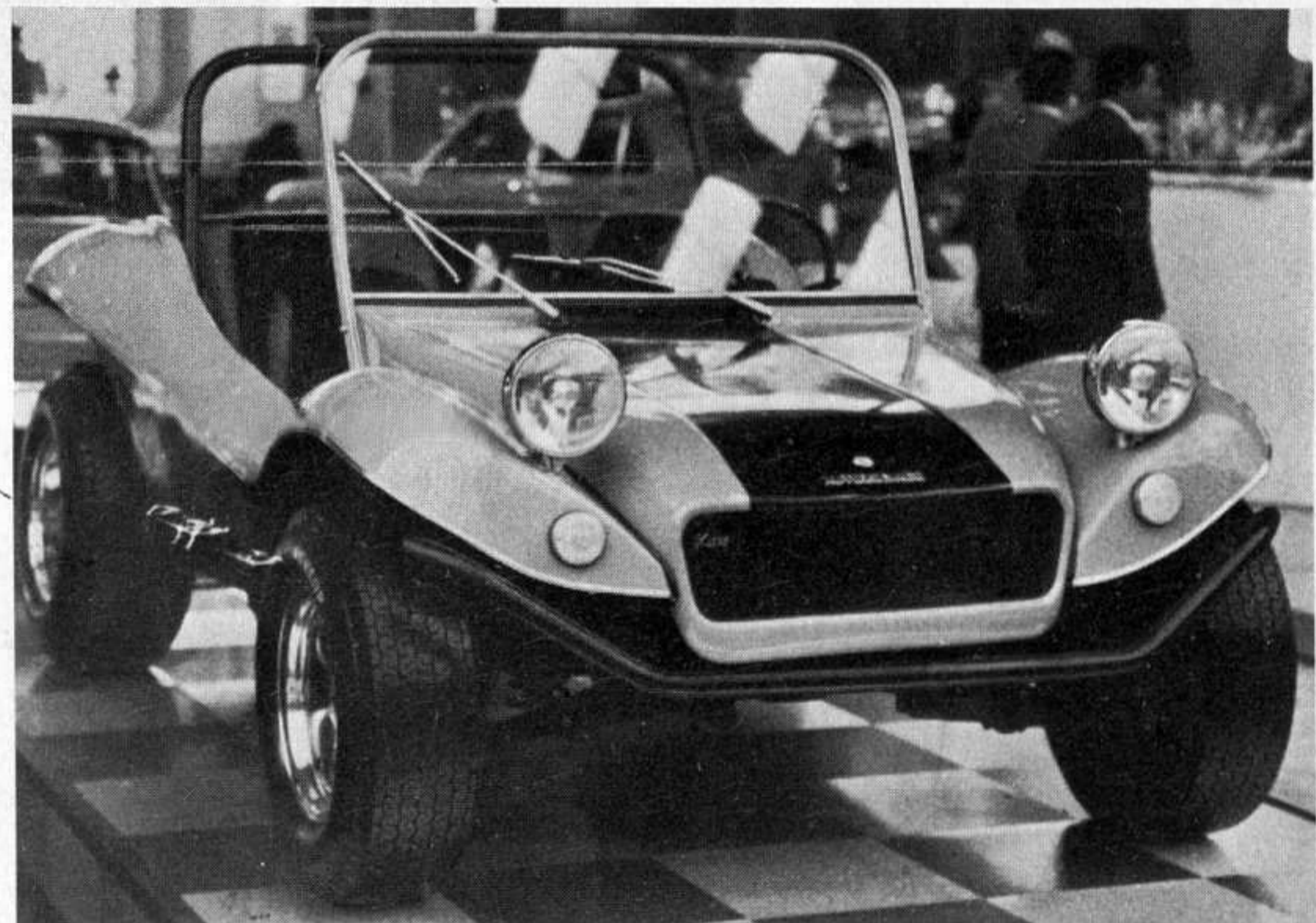
Sopra, l'ultima novità dell'Autozodiaco, la Kirby, che monta un motore di 1107 cc e può raggiungere una velocità di 130 kmh. La sua meccanica è Skoda. Sotto, la Sicra KL, meccanica Volkswagen
