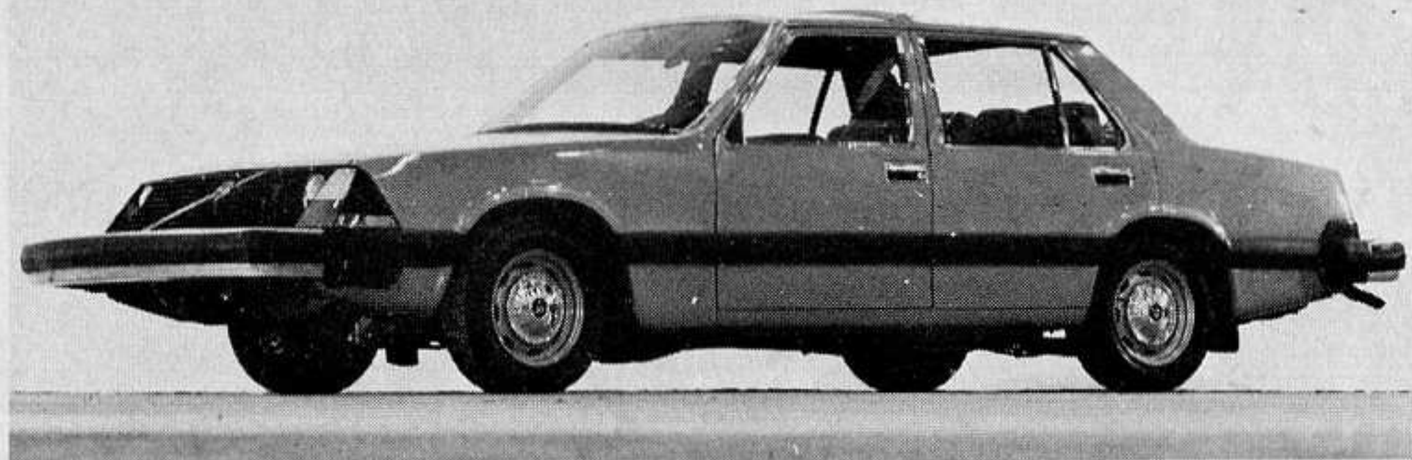
La vettura sperimentale VESC con le sue caratteristiche linee, accettabili sotto il profilo estetico. Sopra a destra: l'enorme paraurti anteriore, fissato su ammortizzatori idraulici longitudinali
