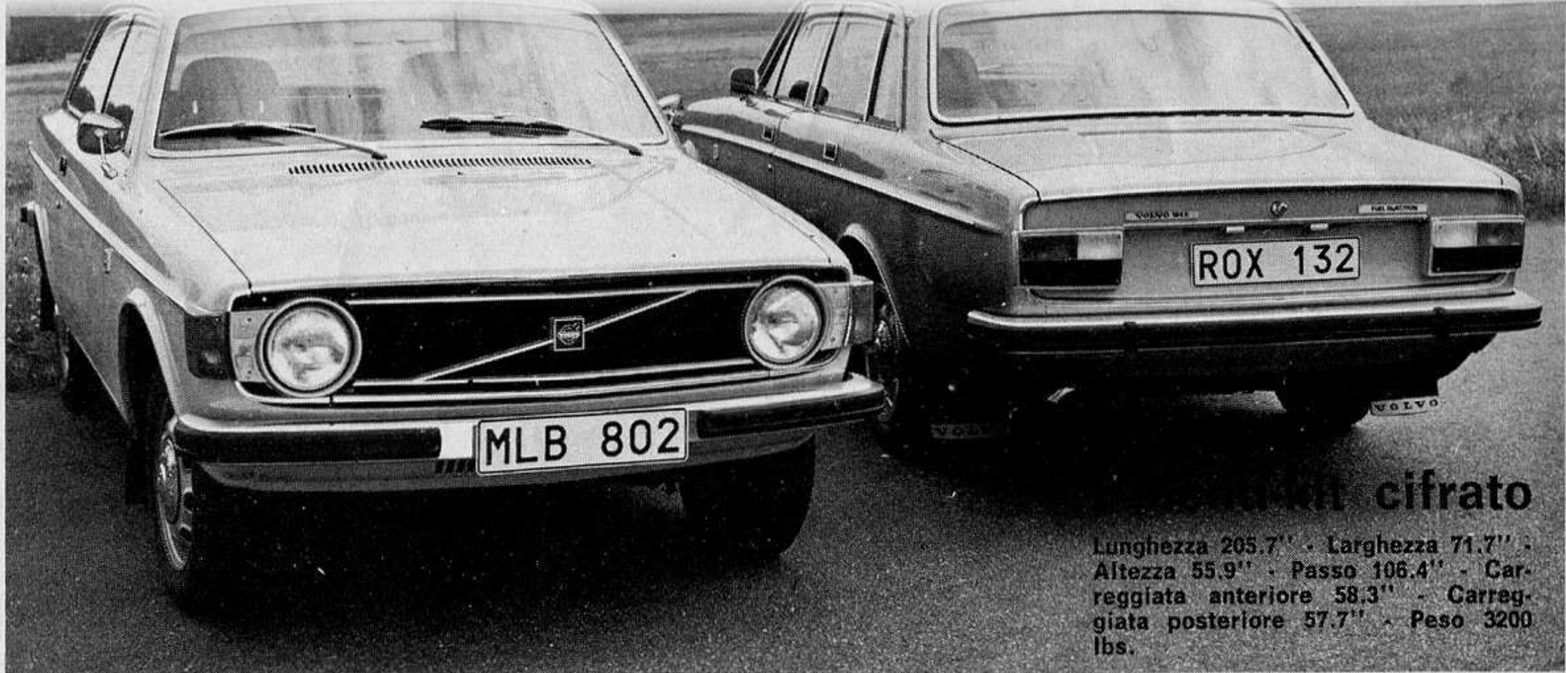
La nuova calandra e le luci posteriori di nuovo disegno, che distinguono esternamente le Volvo 1973
