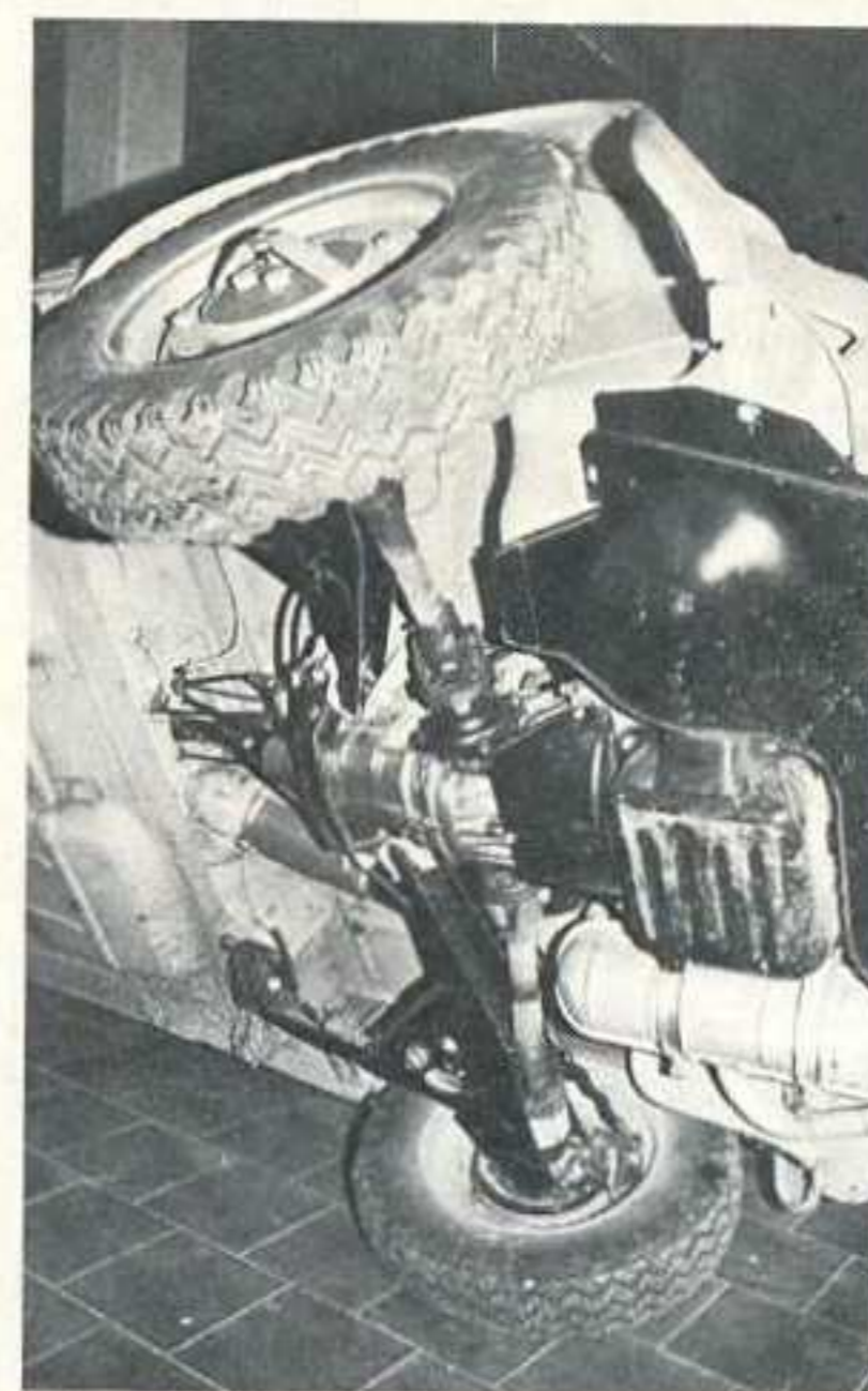
Ribaltato sul fianco destro, il fuoristrada Reggiani derivato dalla Fiat 500 mostra il cambio dotato di autobloccante Colotti
