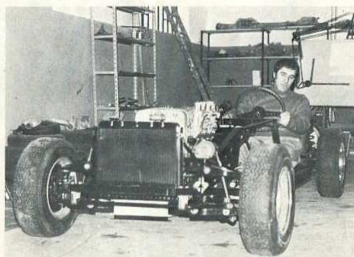
La «sport» di Reggiani vista anteriormente. Sfruttate molte parti motore e sospensioni, della 124 sport
