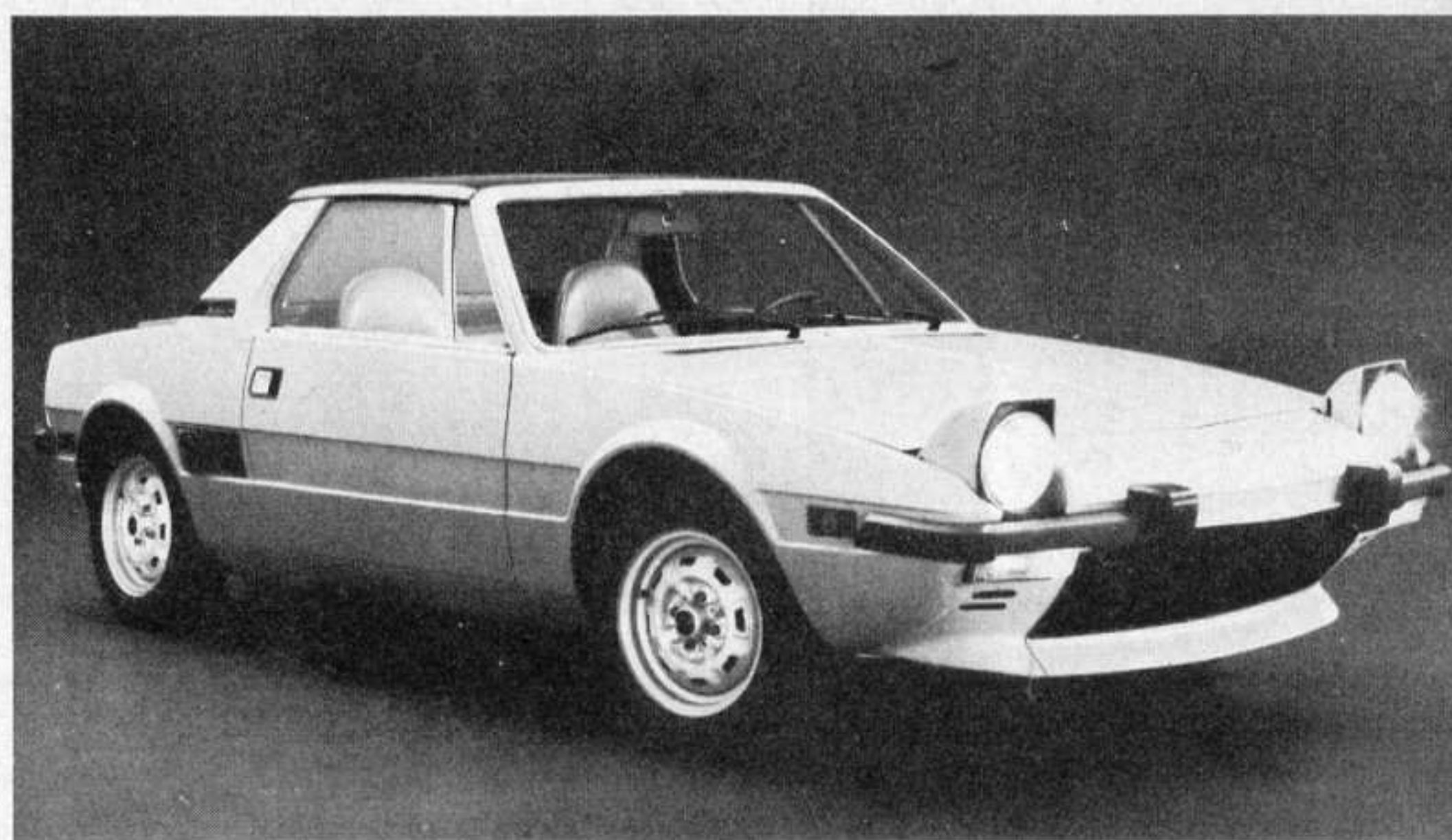
La piacevolissima linea della Fiat-Bertone X 1/9, a fanaleria esposta. Nella parte inferiore del muso, si nota chiaramente il largo spoiler in funzione deportante per l'avantreno alle alte velocità
