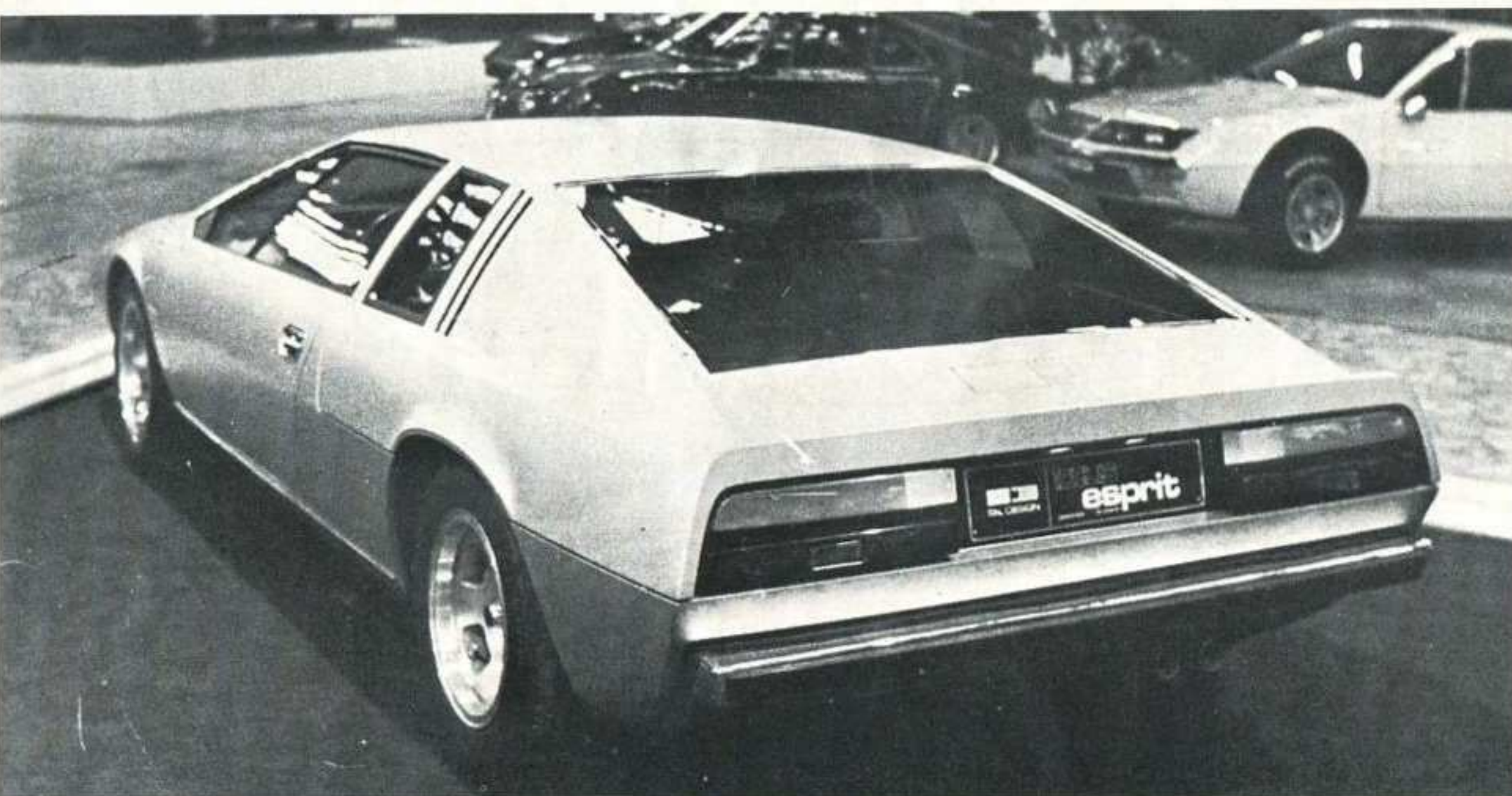
Sopra, un altro scorcio della Esprit della Italdesign, su meccanica Lotus Europa e motore 2000. Il paracolpi anteriore e posteriore è guarnito da un profilo gommato. Sotto, secondo la sua consuetudine Moretti ha presentato un piccolo coupé, questo su telaio 127 a due posti + 2 non molto originale
