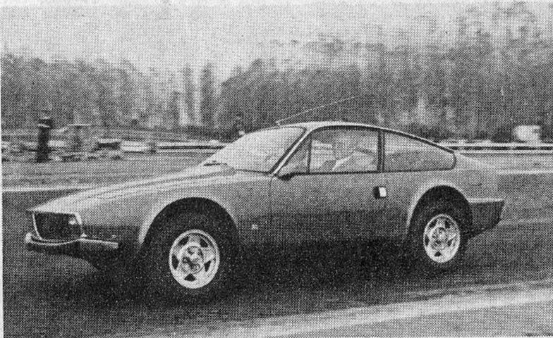
Il dottor Zagato ha provato la pista di Casale con una delle nuovissime Junior Z con motore 1600 che sarà l'unica novità Alfa Romeo al Salone di Torino. Motore da 125 CV SAE, 950 kg., 190 kmh
