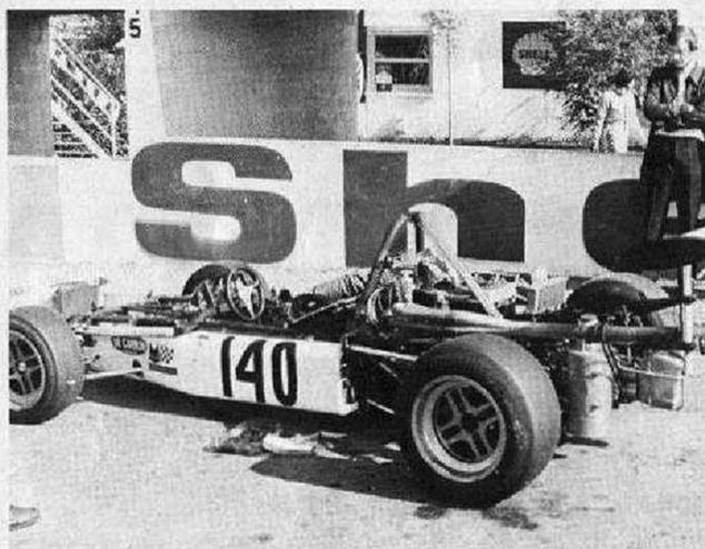
Finalmente una Brabham BT 38 all'altezza delle altre monoposto: è la macchina di Conny Andersson, completamente modificata nel retrotreno, con alettone molto arretrato e un solo radiatore laterale tipo F.2
