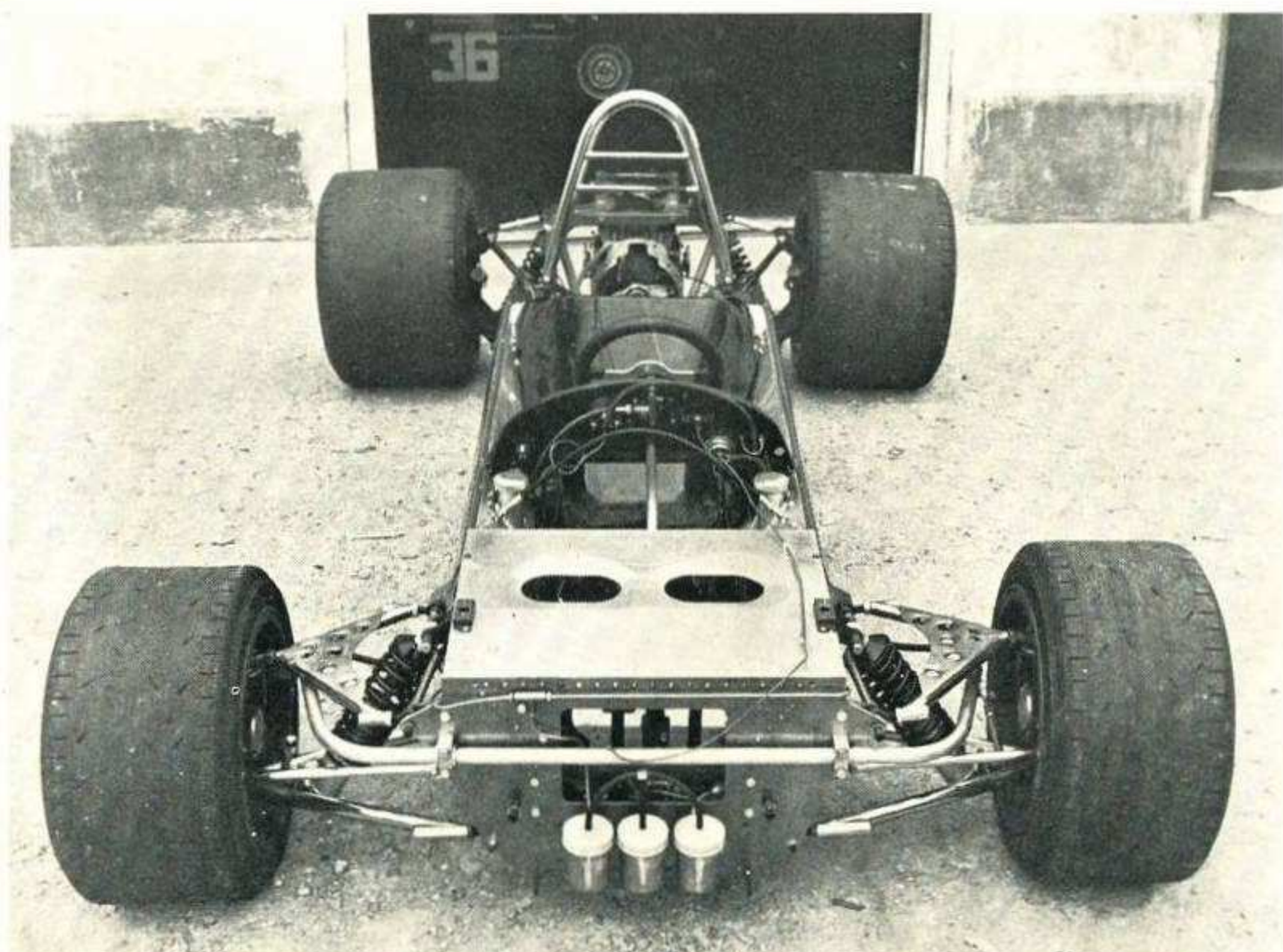
La nuova SMR Formula 2 di fronte: si può ben vedere il telaio monoscocca, le sospensioni anteriori tradizionali che utilizzano montanti derivati dalle March F. 2
