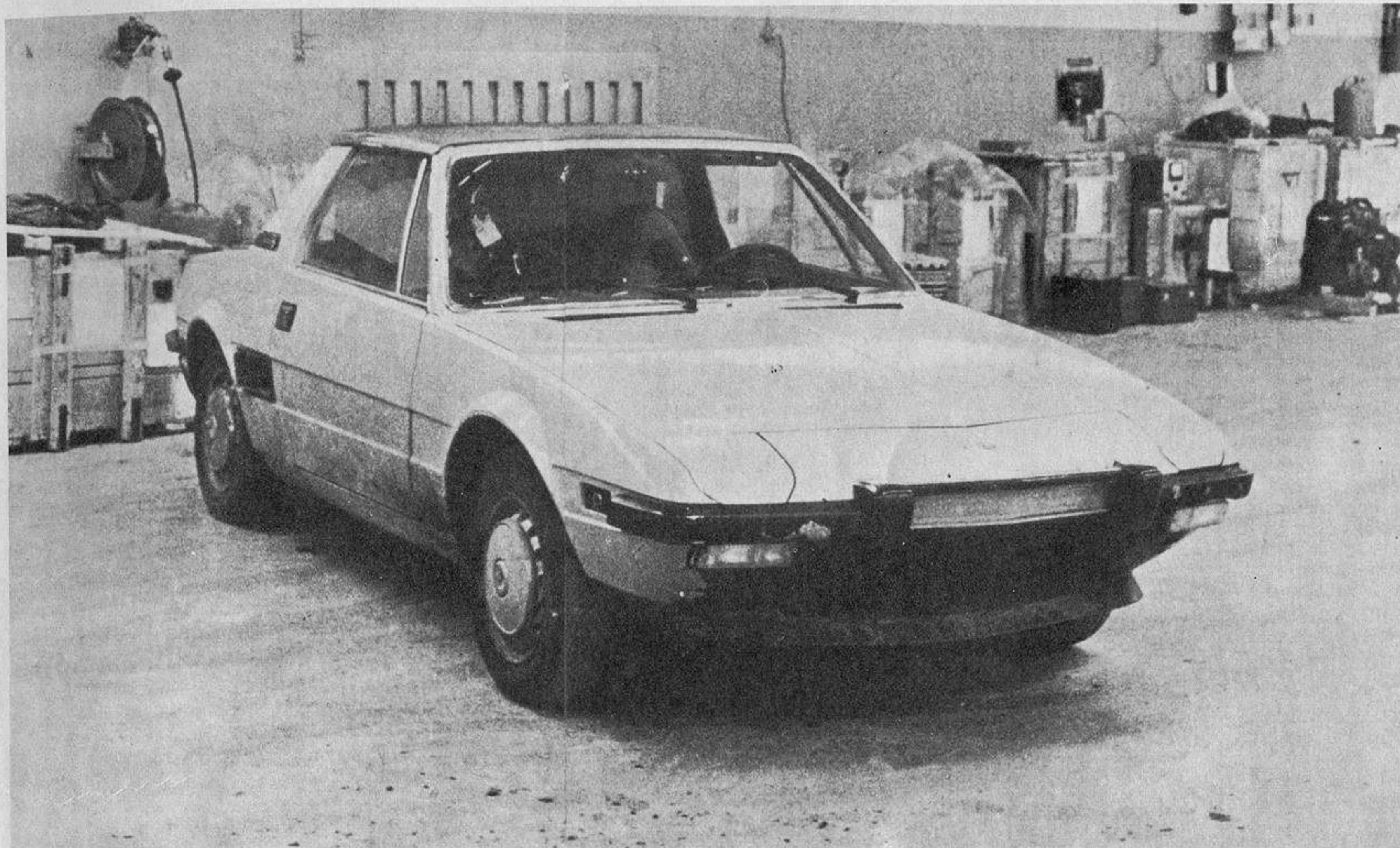
◀ A sinistra, l'atteso coupé Bertone con motore 128-1300 posteriore centrale fotografato, in versione definitiva, a Rio Gallegos. Molto alto il paraurti, con sotto la presa d'aria del radiatore anteriore. Velocità stimata 175 kmh. Sotto, muso e coda della 126, versione definitiva ▼
