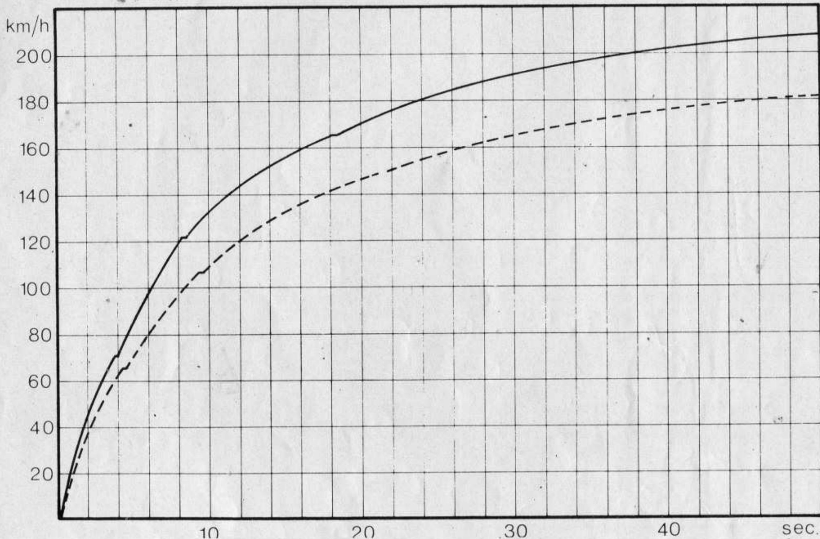
A destra, una vista del 6 cilindri Dino preparato da Foglietti, e che rende una trentina di CV in più del normale. Sotto, diagramma accelerazioni. In tratteggio, il Dino 2400 cc di serie
