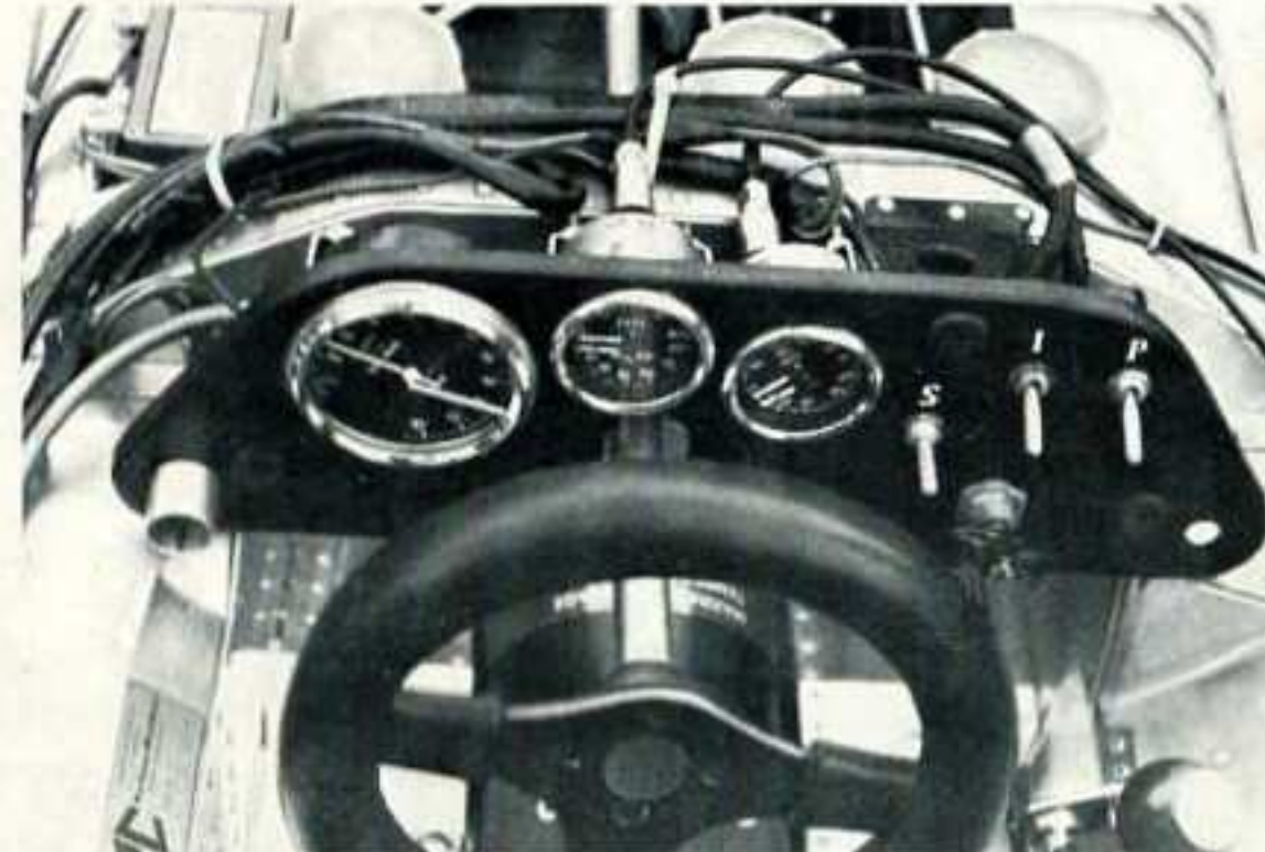
Il pannello degli strumenti. Il contagiri ha il limite massimo a 10.000, regime autorizzato per i motori Cosworth serie 10; la bombola dell'impianto antincendio è posta sotto le gambe del pilota
