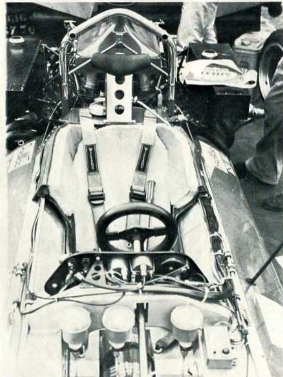
La struttura dell'abitacolo è molto semplice e lineare. Molte soluzioni ricordano quelle adottate dalla Surtees. A destra: la macchina priva della parte superiore della carrozzeria, mette a nudo l'abitacolo e le canalizzazioni tutte tradizionali
