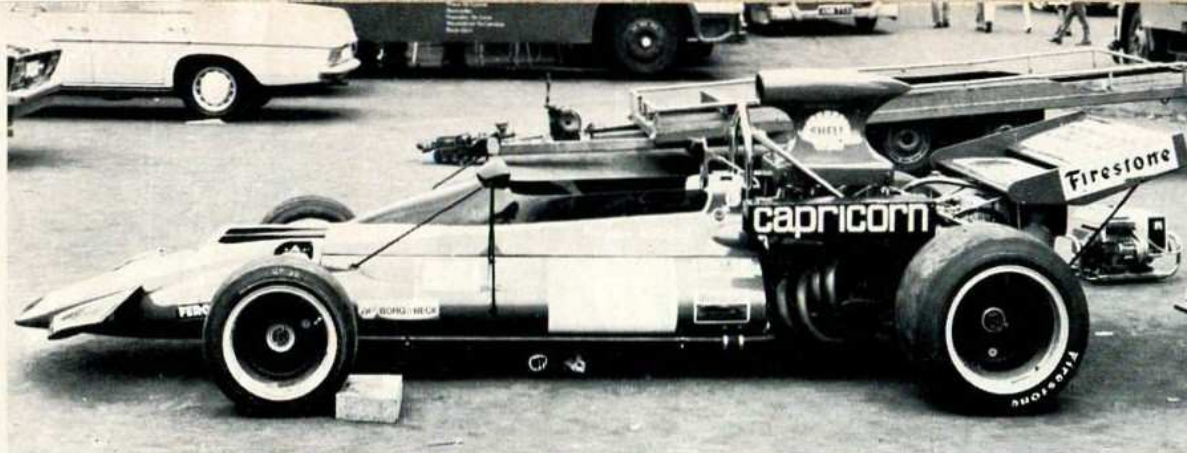
Ecco (sopra) la Connew vista di profilo. Come si vede le linee sono classiche e pulite. Sotto a sinistra: la linea filante della nuova macchina è caratterizzata dal muso a cuneo, anche se il radiatore dell'acqua è in posizione anteriore. Sotto a destra: Peter Connew, progettista della nuova « Darnval »
