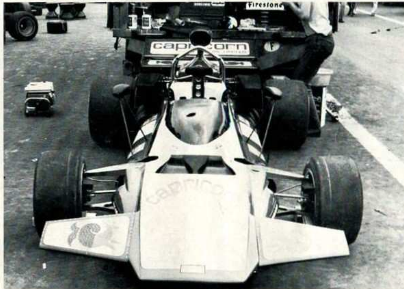
Ecco (sopra) la Connew vista di profilo. Come si vede le linee sono classiche e pulite. Sotto a sinistra: la linea filante della nuova macchina è caratterizzata dal muso a cuneo, anche se il radiatore dell'acqua è in posizione anteriore. Sotto a destra: Peter Connew, progettista della nuova « Darnval »
