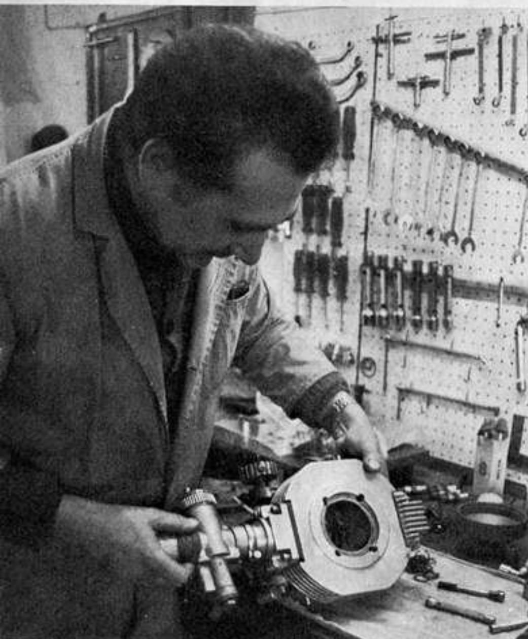
Armadori presenta uno dei suoi tanti «studi» giovanili, una testata quattro valvole bialbero a cinghia dentata realizzata nel '64 per un 250 monocilindrico Ducati. I due tecnici bolognesi stanno anche ricostruendo un 8V Cisitalia
