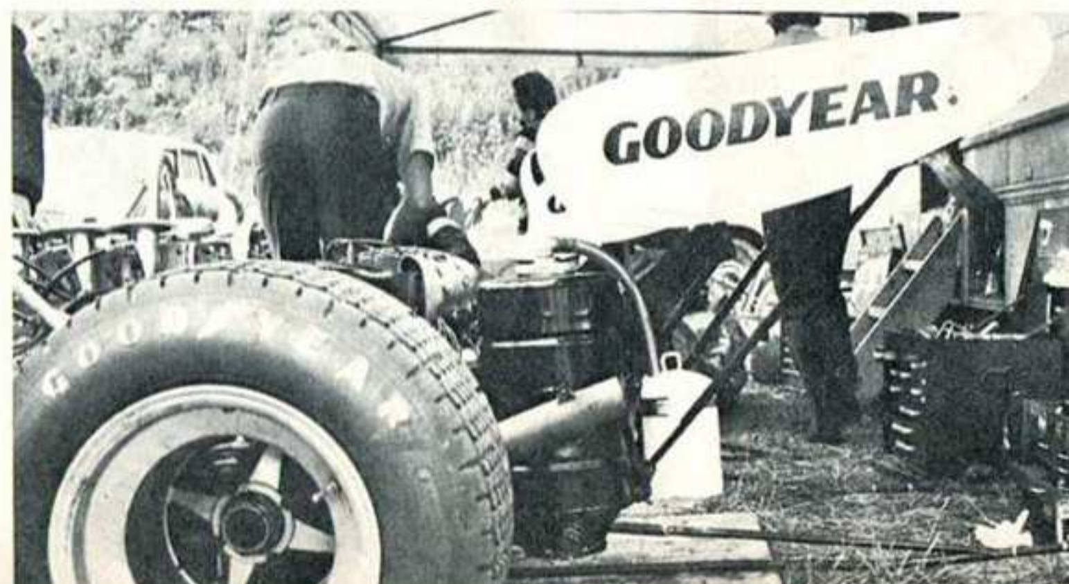
Sopra a sinistra, la nuova presa d'aria ricavata in fusione per i freni posteriori della Ferrari. Qui sopra, l'imponente gruppo serbatoio-radiatori olio delle Ferrari. L'alettone è molto arretrato
