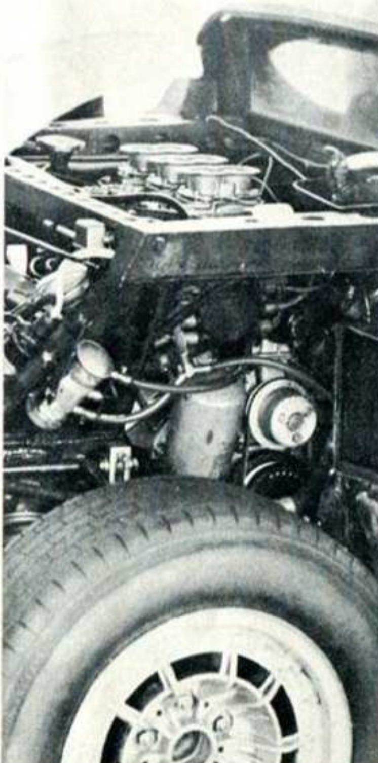
Il compatto 6 cilindri a V della Dino è inserito perfettamente nel traliccio di tubi scatolati che struttura la parte posteriore
