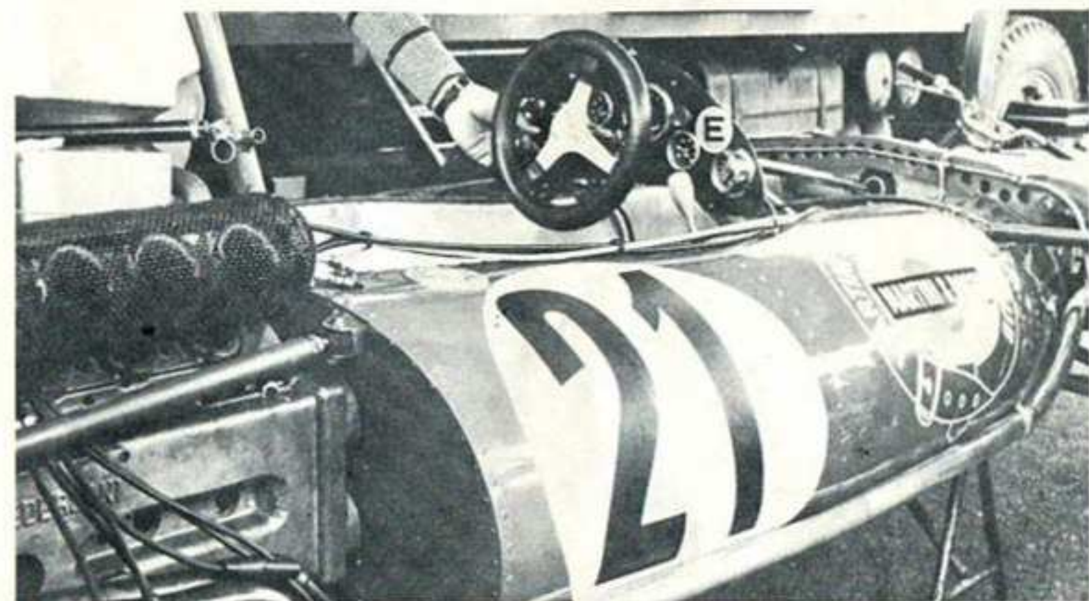
La parte posteriore della Tecno-Martini. Nella prossima versione, dovrebbe essere più «pulita». Sotto, si nota, sopra alla testata destra, l'attacco alla scocca del puntone che poi ha ceduto, provocando il ritiro della macchina
