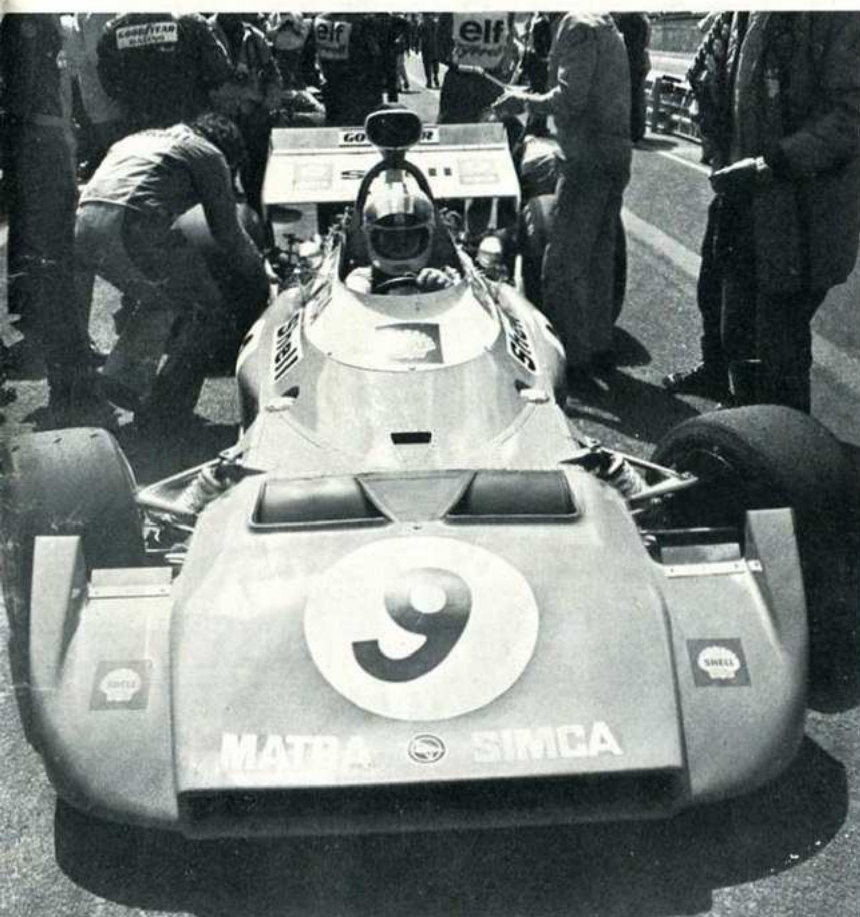
La nuova linea della Matra 120 D. E' cambiato solo in corpo centrale, mentre il musetto è rimasto invariato. Sotto: la nuova forma della scocca della Matra è ben visibile in questa foto (foto LINI)
