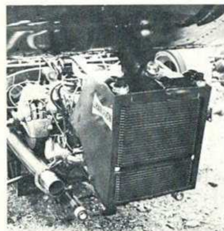
Il serbatoio olio con i radiatori che ora, sulla Lotus-JPS di Fittipaldi, supporta anche l'alettone
