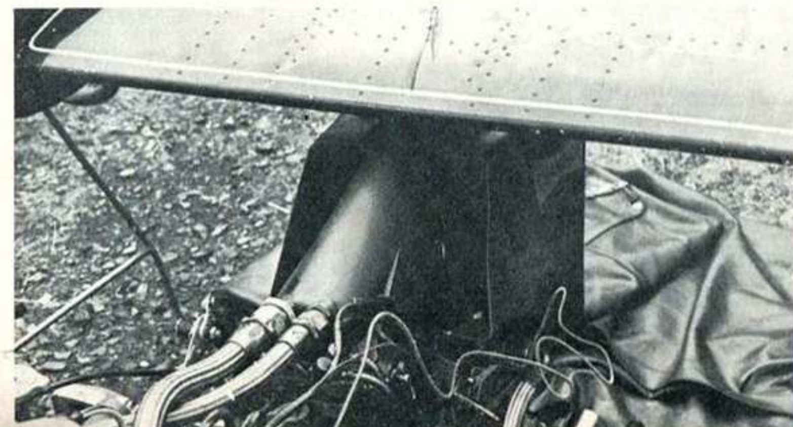
Il serbatoio olio con i radiatori che ora, sulla Lotus-JPS di Fittipaldi, supporta anche l'alettone
