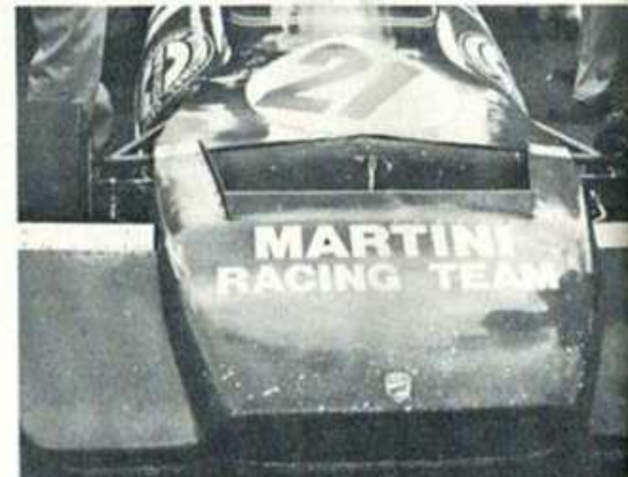
Il muso della Tecno vista a Clermont Ferrand è ora meno ampio e più efficiente di quello visto a Vallelunga e a Nivelles
