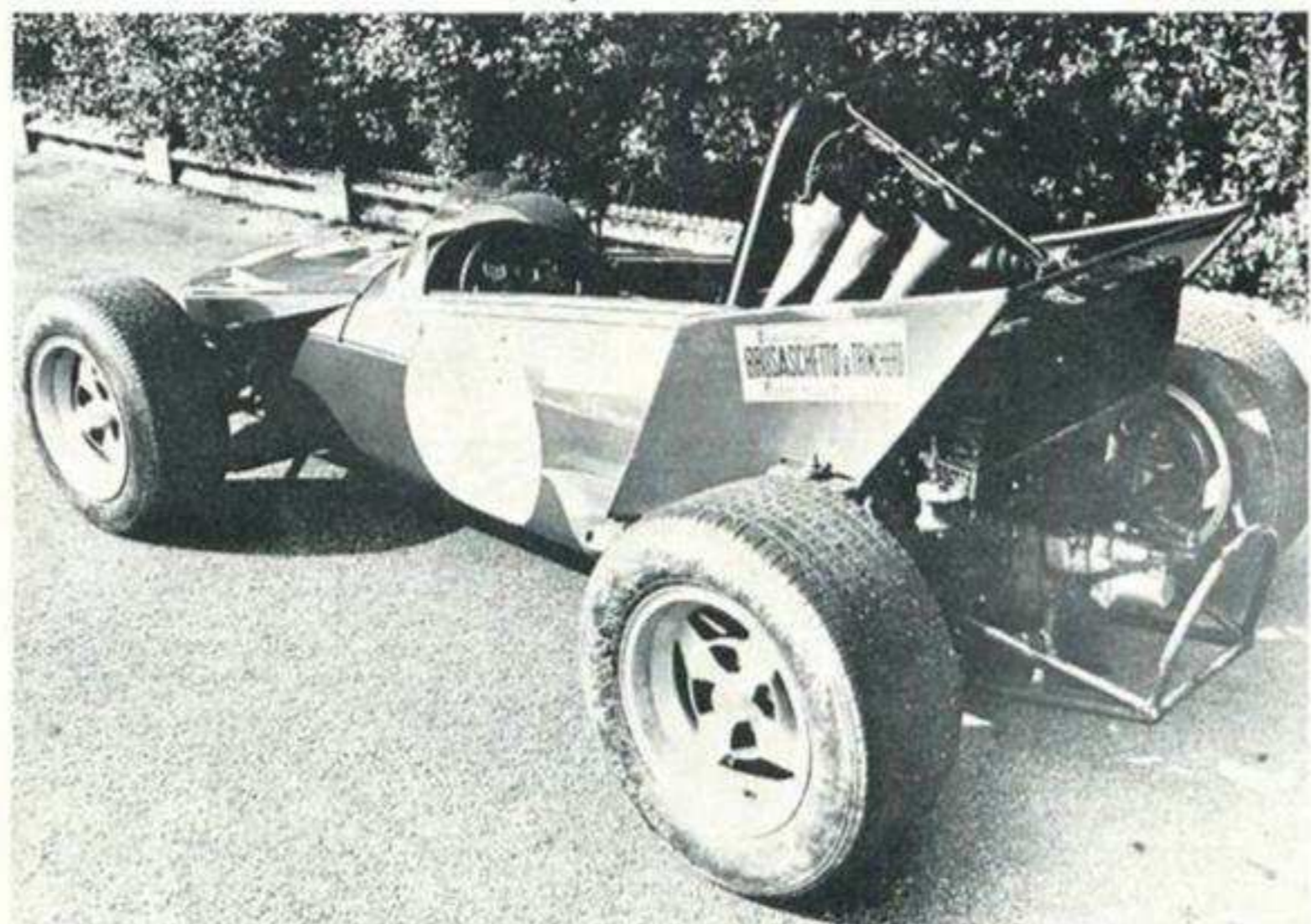
Una vista posteriore della CRM-DKW condotta in corsa da Franco Negro. Il radiatore acqua è posteriore, dietro ai grossi scarichi, mentre il cambio è quello della Fiat 500. Presto si monterà un 1000
