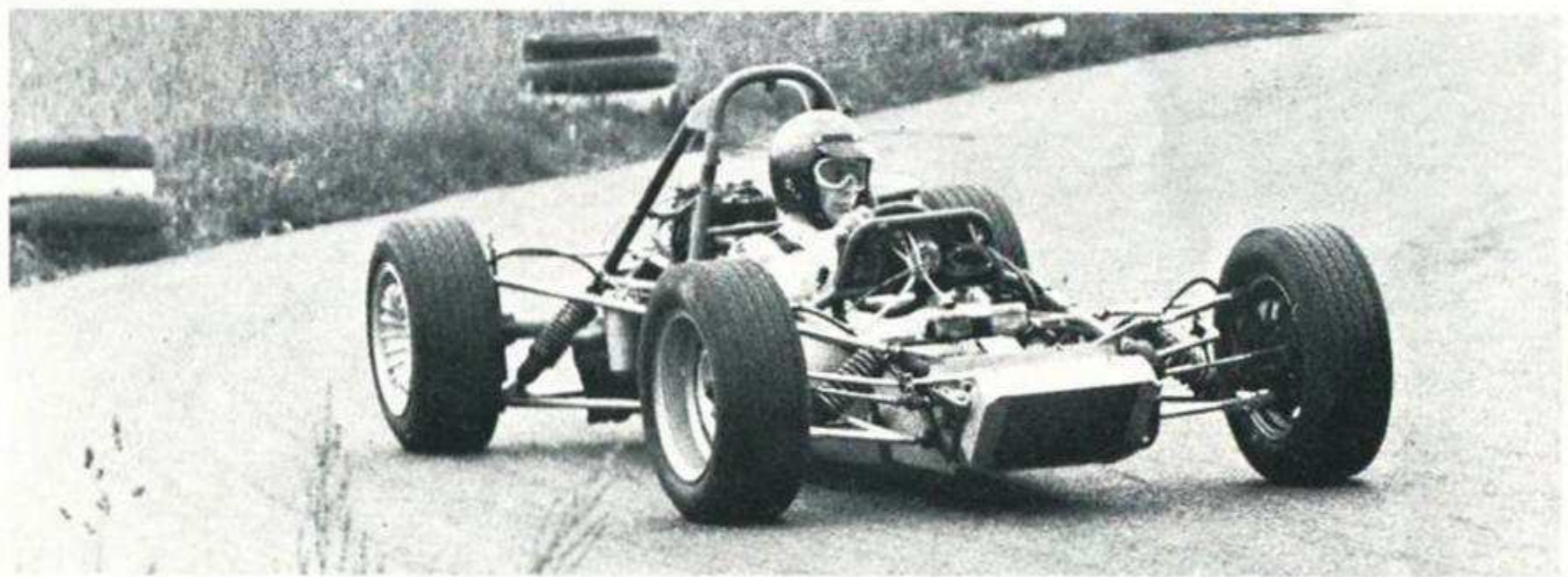
A destra, il « mostro » di Donato Angelillo. Il motore è il 600 D portato ad 850, montato a sbalzo. Il telaio base è quello della 500 Fiat, così come il cambio. Sotto, Vincenzo Narcisi impegnato nella gara vincente di aprile, effettuata con la sua F. Ford Bellasi priva di carrozzeria, dotata però di pneumatici racing
