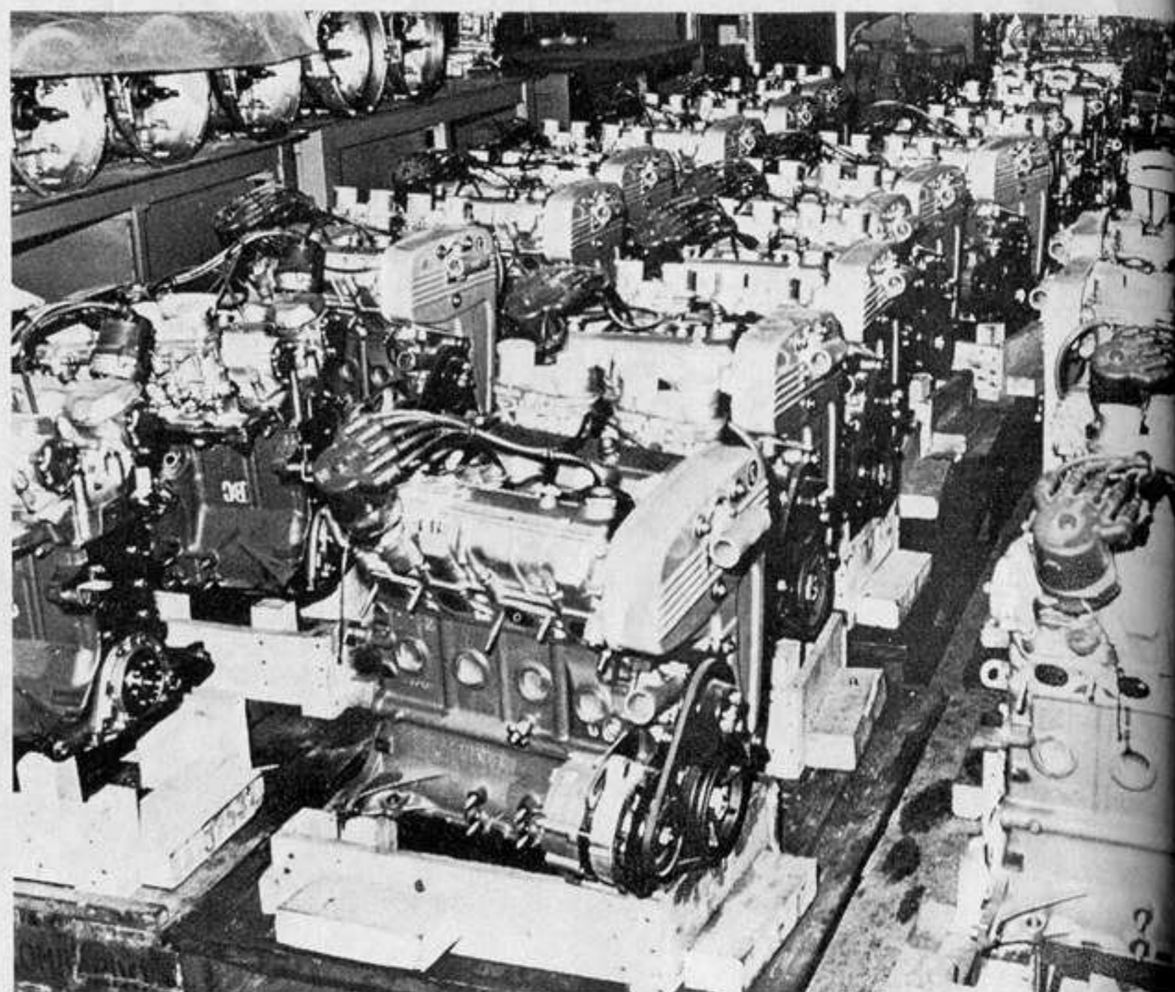
Una bella «infilata» di motori pronti per il montaggio. Com'è noto, si tratta dei 4 cilindri 1608 della Fiat 124 coupé o spider, con 110 CV
