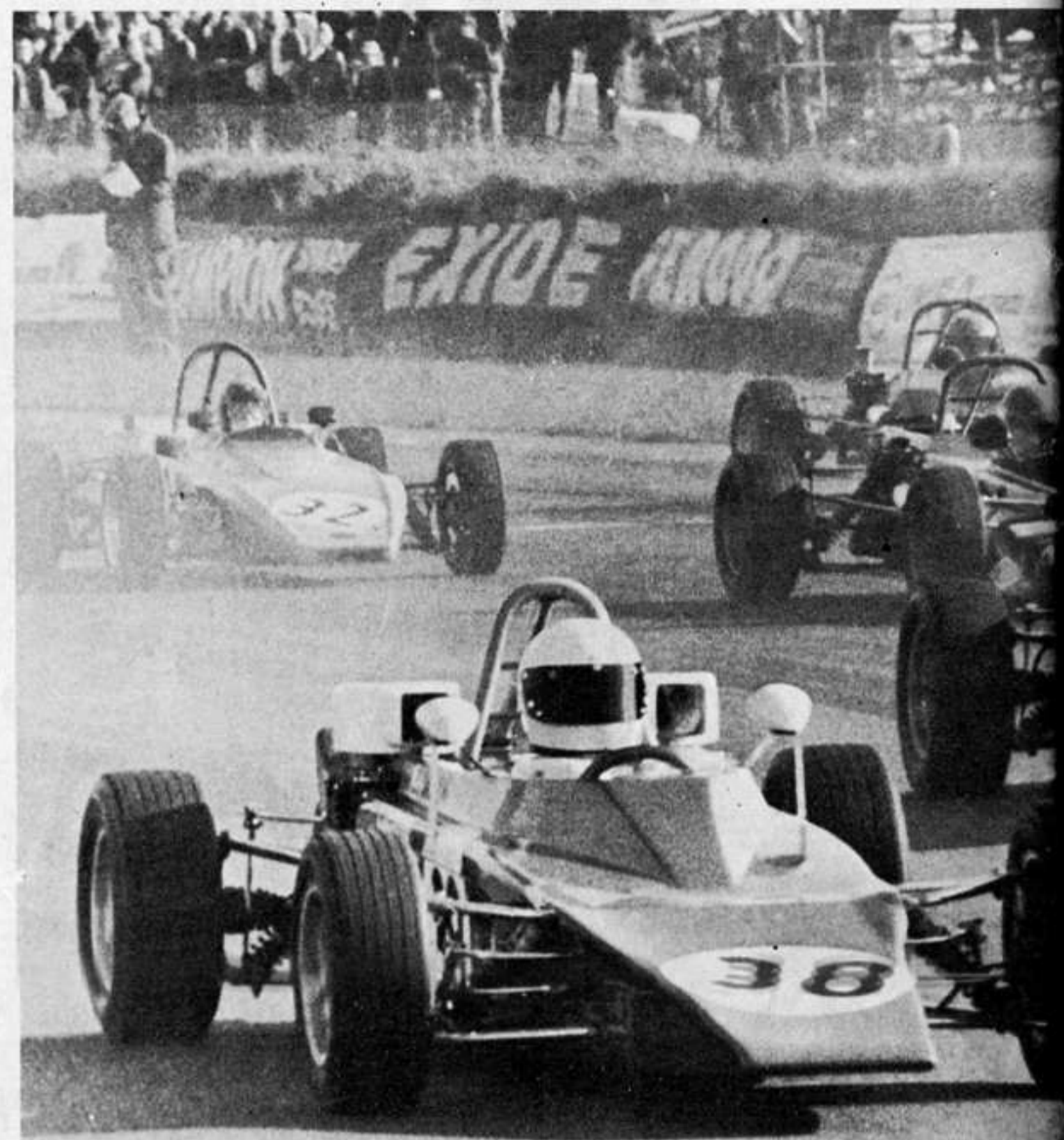
Ecco le super-vee (o vau, come dicono i tedeschi), le minimonoposto che con i loro 140 hppotenza, insidiano la supremazia delle F3 nelle formule minori, ottimo banco di scuola per i giovani piloti. In alto, una tedesca, la « Motul » che adotta una struttura mista tubi-monoscocca. Nella foto sotto, due « Horag Has 4 » in azione
