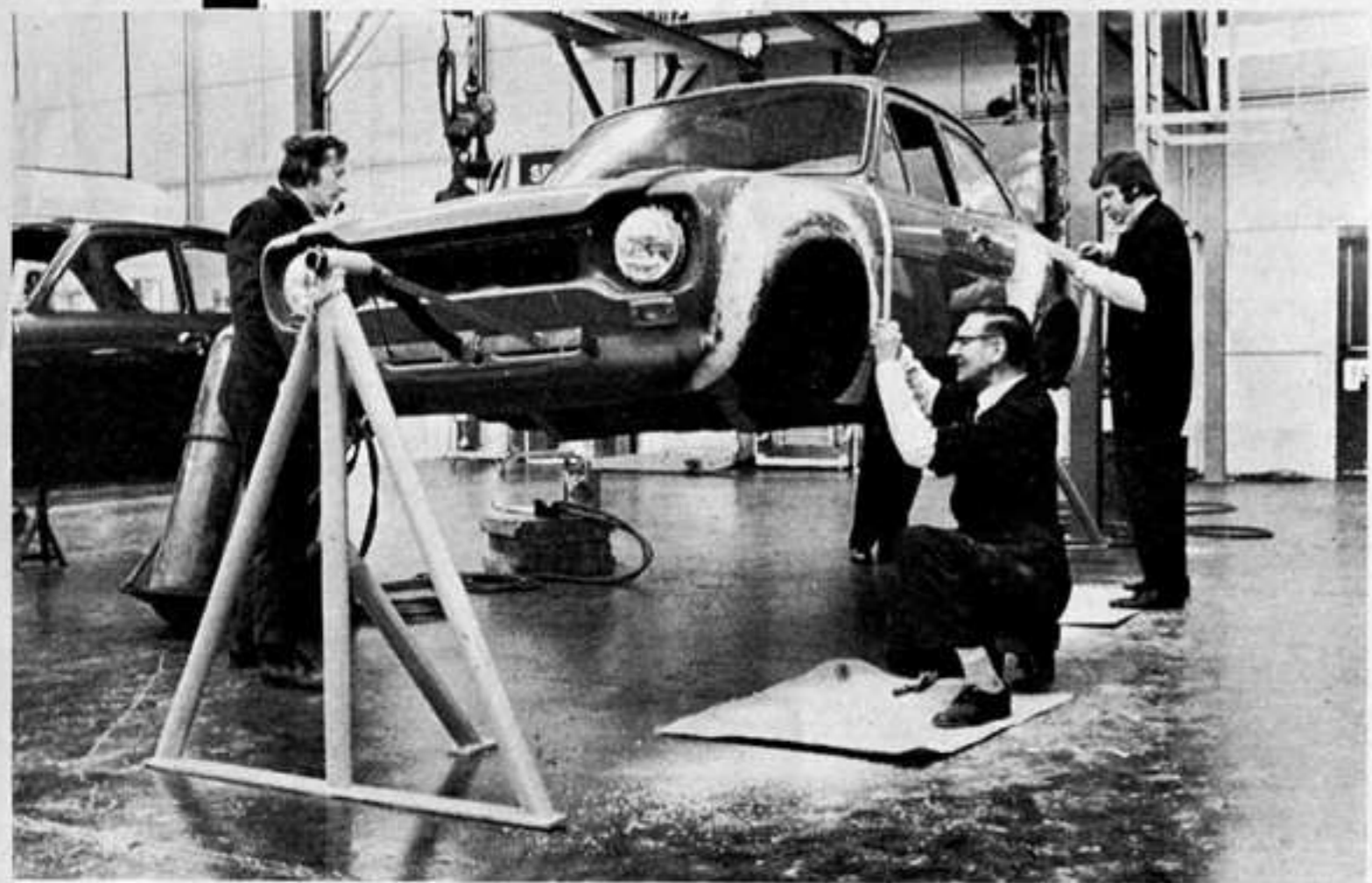
Per alloggiare ruote e pneumatici larghi (sopra) vengono saldati alle carrozzerie specie di « arcate », sistema più economico. A destra: varie parti disposte su uno speciale ripiano. Sotto: una delle novità: a destra di questo motore Mexico c'è un compressore Holset
