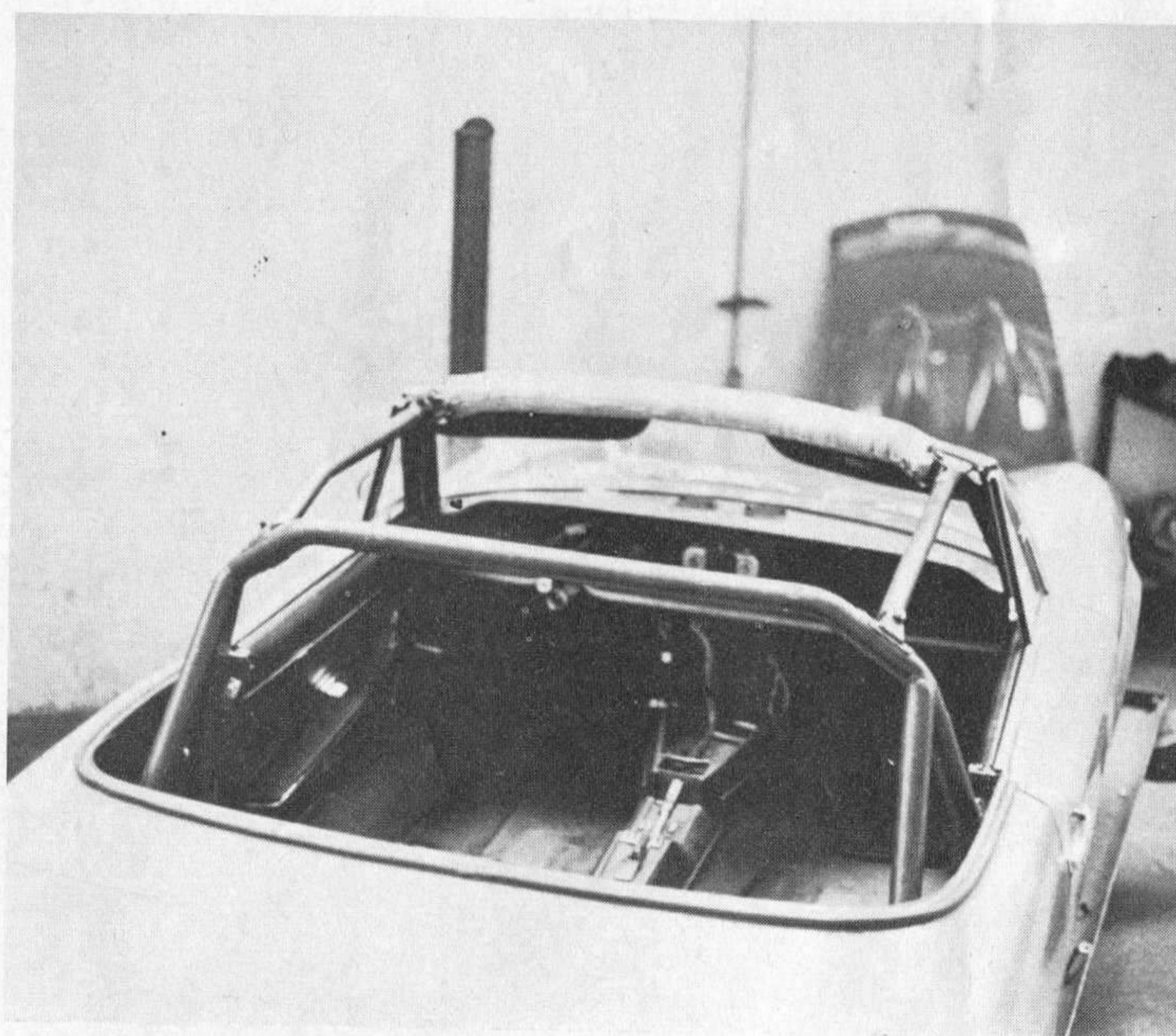
Sopra, Benzing scrive quello che Jacoponi ed Avidano gli dicono a proposito della preparazione rallies della 124 spider. A destra, il bellissimo roll-bar a gabbia realizzato dall'Abarth
