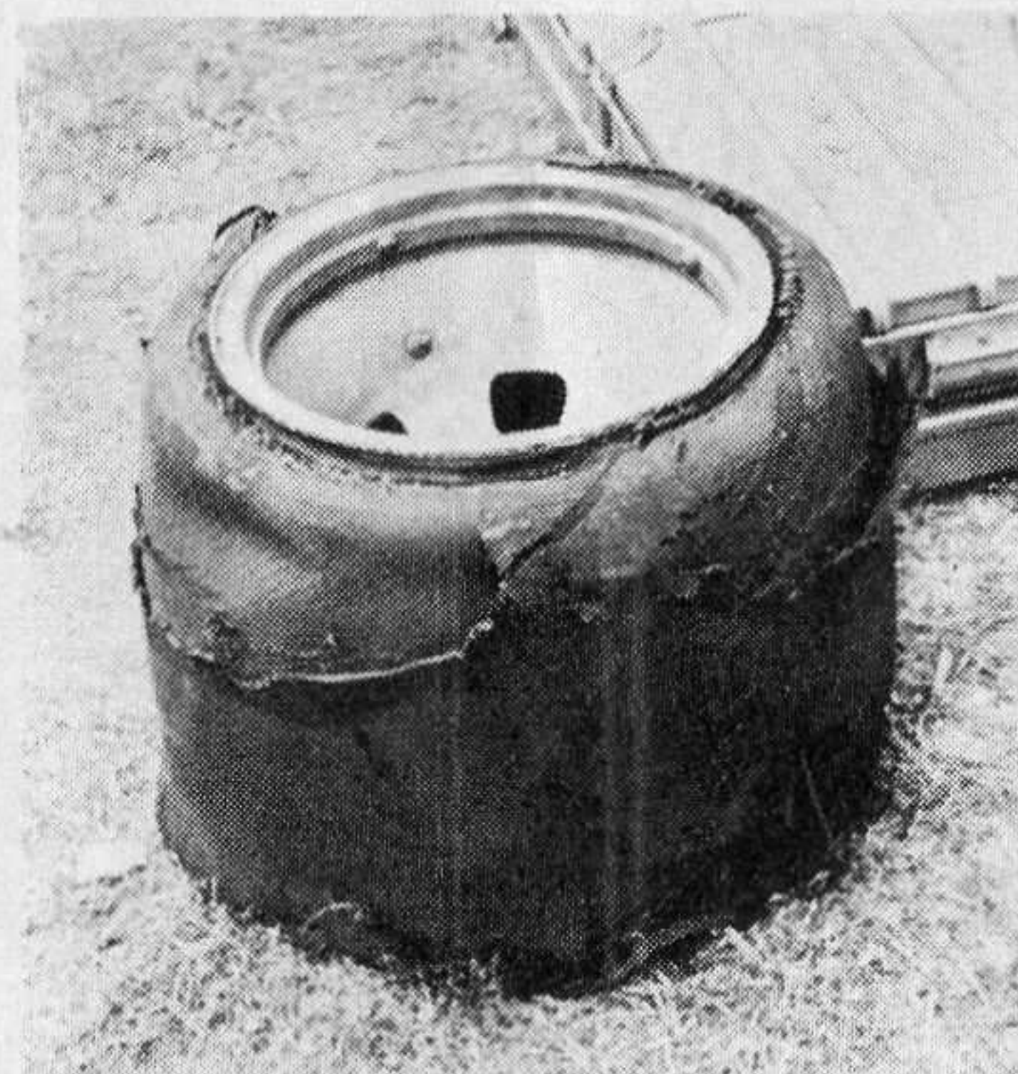
Sopra, uno dei M.T. Goodyear dell'Alfa di Stommelen-Revson, con un inizio di dechappaggio. Sotto, non stavano certo meglio questi Firestone della Ferrari...
