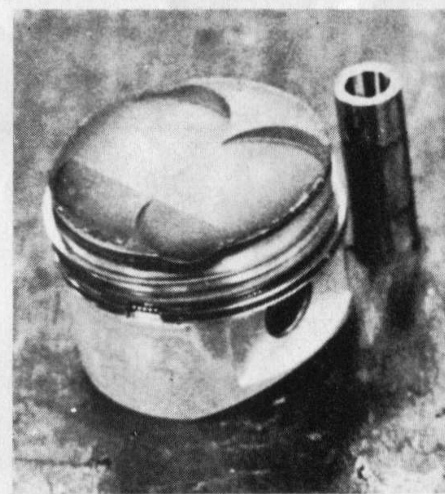
A sinistra, una biella dell'8 cilindri Cosworth. Esse non sono in titanio, e reggono velocità medie del pistone che superano i 21 metri al secondo. A destra, il «cuore» del DFV, uno dei suoi 8 pistoni forgiati dalla Cosworth
